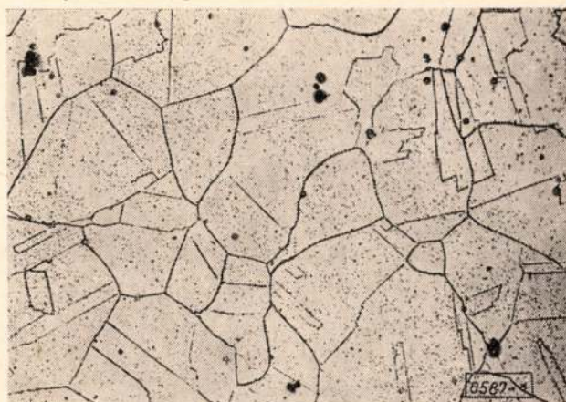
2. ábra. Csiszolatfőzés szerint kristályközi korrózióra hajlamos ferrit-austenites acél. Az eredeti 250 × nagyítás
