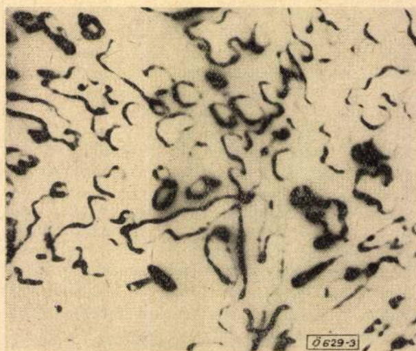
3. ábra. Ticonal 400 mágnesanyag elektronképe \alpha_\gamma kiválásokkal ( 300 \times elektronkép)
