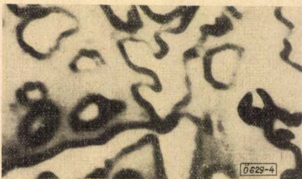
4. ábra. A mikroszondás vizsgálat helye, a vonalmenti koncentrációeloszlás vizsgálóvonalával. ( 1200 \times elektronkép)
