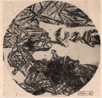
10. ábra. Indefinite-chill henger szövete. N = 500 ×
