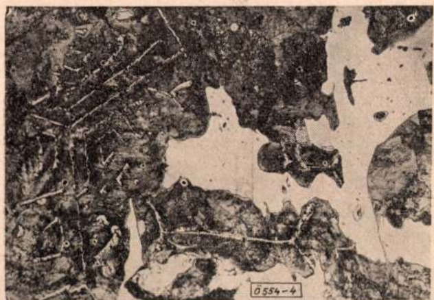
4. ábra. Nióbiium-molibdén komplex karbidok az öntöttvasban. 30%-os alk. HNO_3 , N = 300 \times
