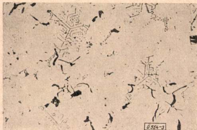
3. ábra. Nióbiium-molibdén komplex karbidok az öntöttvasban. Maratlan, N = 100 \times
