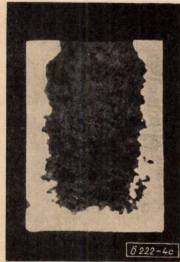
4. ábra. Öntészeti nyersvasak kiöntési próbái (acélnyersvas + önt. töredék)
