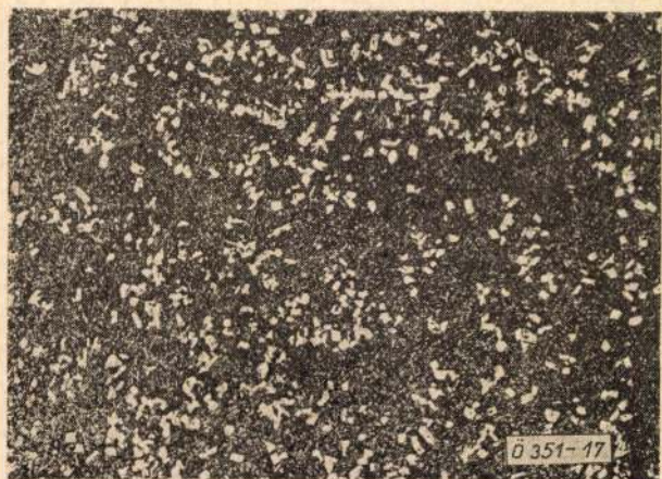
17. ábra. Modifikált adag mikrofelvétele. A primer Si a TGL szerint 2. finomságú. N = 50 \times
