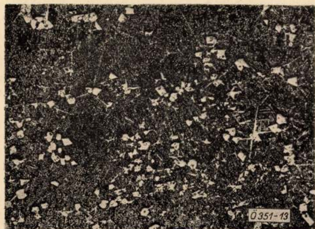
13. ábra. Modifikálatlan ötvözet mikrofelvelele pihentetés után. A primer Si a TGL szerint 2—3 finomságú. N = 50 \times
