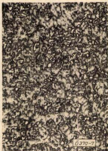
7. ábra. A modifikátor mennyiségét 1%-ra emelve, egyébként azonos körülmények között igen finom szemmagyságú (TGL szerint 1. fokozatú) és eloszlású szilíciumkristallitokat kaptunk. NaOH-val maratva. N=50\times
