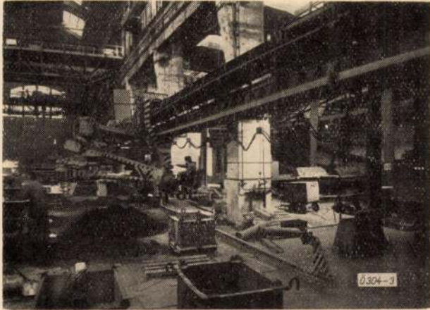
3. ábra. Az egyedi nagy öntvények formázóterülete a szovjet gyártmányú 296. típusú konzolos homokröpítővel
