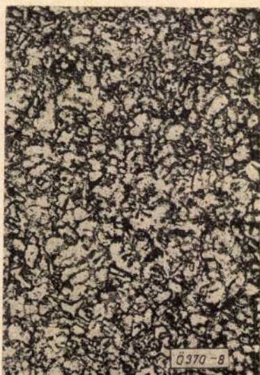
8. ábra. 21% szilíciumtartalmú hipereutektikus szilumin primer szilíciumának szemcsenagysága a TGL szerint 2. és 3. fokozat közötti. NaOH-val maratva. N=50\times
