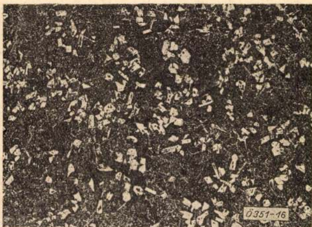
16. ábra. Ugyanaz az adag modifikálás és heracloréanos gáztalanítás után. A primer Si durvult, a TGL szerint ismét 3 finomságú. A fürdő primer Si kristallitokban elszegényedett. N = 50 \times
