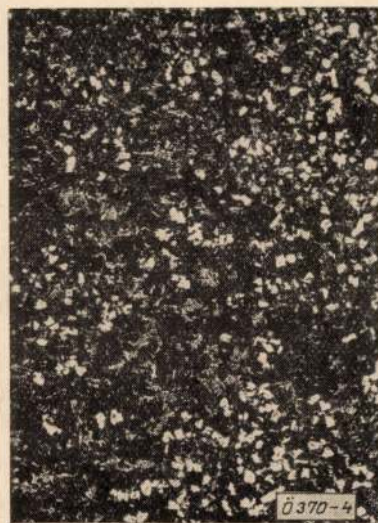
4. ábra. A Barth féle készítmény mennyiségét 1%-ra növelve (a kezelési hőmérséklet 800 °C) a primer szilíciumkristályok szemcsemérete finomodott (TGL szerint 1—2. fokozat közé). NaOH-val maratva. N = 50 ×
