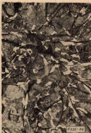
2. ábra. A magyar öntészeti nyersvas felhasználásával olvasztott öntöttvas szövetének változása alumínium hatására. 4%-os alk. pikrinsavval maratra. N=300\times . a) kiindulási öntöttvas, b) 0,2% Al
