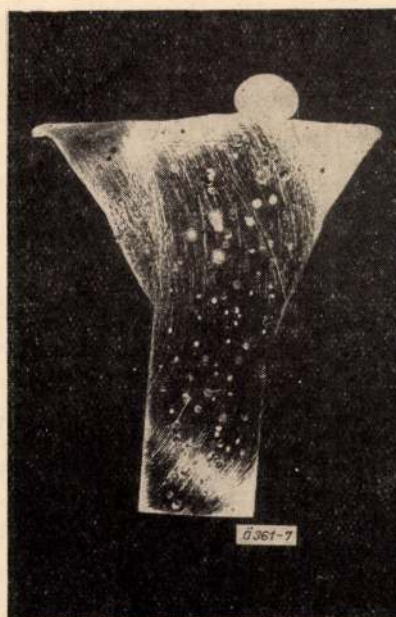
7. ábra. A 6 ábrán látható öntvény tápfejének hosszmetzete
