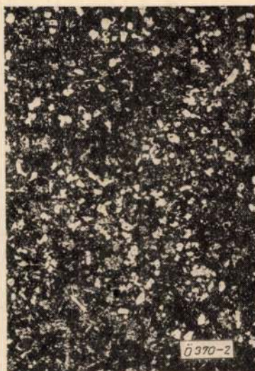
2. ábra. 17% szilíciumtartalmú hipereutektikus szilumin mikroszövege 0,5% Barth féle készítménnyel 800 °C-on való kezelés után. A primer szilícium szemcsemérete a TGL szerint 2. fokozat. NaOH-val maratva. N = 50 ×
