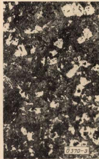
3. ábra. Ugyanaz, mint a 2. ábrán, de 850 °C-on modifikálva. A primer szilícium szemcsemérete 3-asnál durvábbra nőtt. NaOH-val maratva. N = 50 ×
