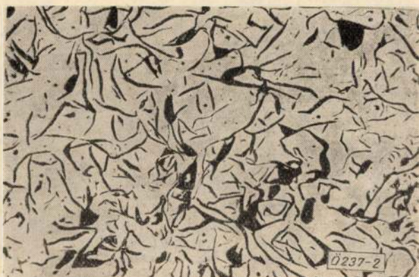
2. ábra. Optimális adagból olvasztott Ö. v. 10 szabványos minőségű öntöttvas grafitképe. N=100X
