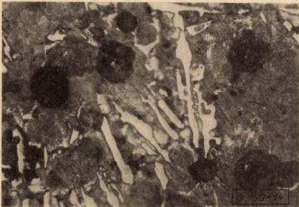
14. ábra. Eutektikus tartózkodási pont nélkül kristályosodott gömbgrafitos öntöttvas
