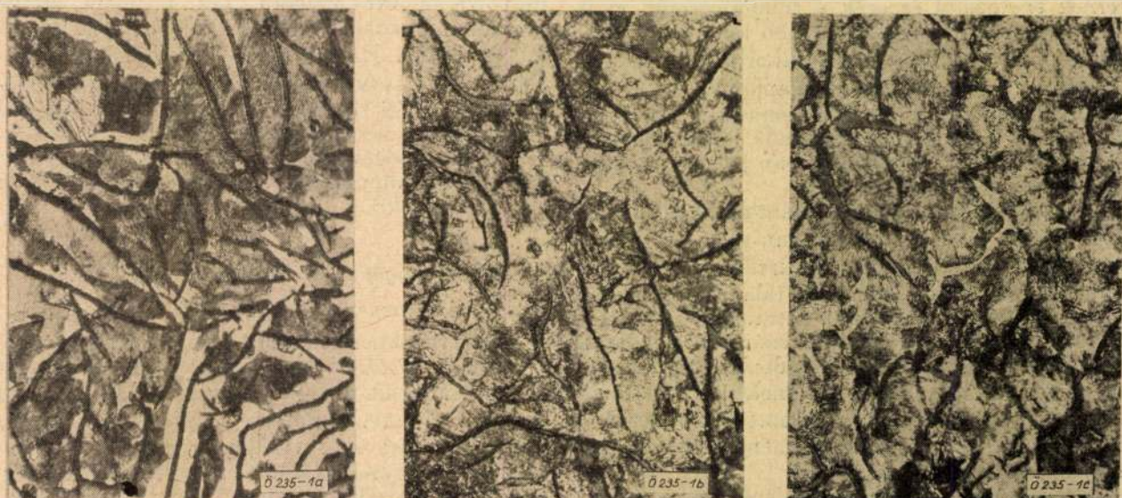
1. ábra. A szovjet nyersvas felhasználásával olvasztott öntöttvas szövetének változása ón és antimon hatására. 4%-os alk. pikrinsavval maratta. N=300\times . a) — átolvasztás után; b) — 0,1% Sn; c) — 0,05% Sb
