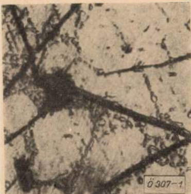
1. ábra. 1,5% Fe-tartalmú \alpha -AlSi10Mg ötvözet szövetképe. N = 400 ×
