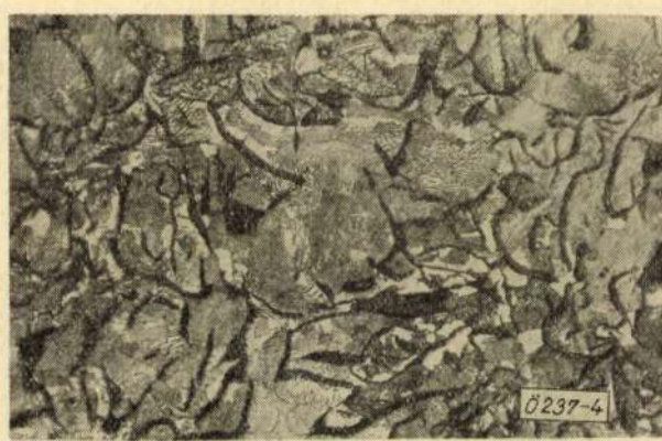
4. ábra. Optimális adagból olvasztott Ö. v. 20 szabványos minőségű öntöttvas szövetképe. N=250×. Nútállal maratva
