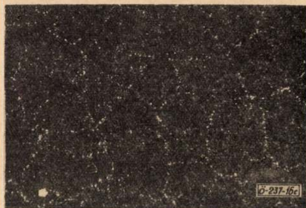
16. ábra. Az eutektikus cellák változása antimon, réz és ólom együttes hatására. 10 %-os alk. HNO_3 -mal maratva N = 10 \times
