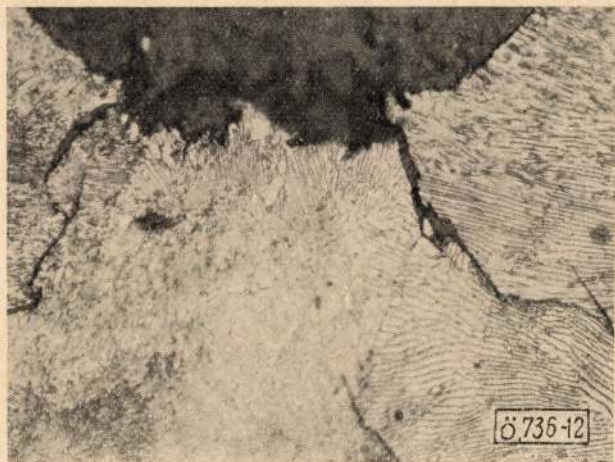
12. ábra. Gömbgrafitból kiinduló grafiterek és lemezes perlit. N = 800 \times
