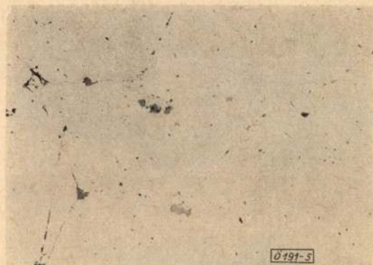
5. ábra. A középsori előnyújtó henger szennyezett primer kristályhatárai maratás nélkül. N = 150 \times
