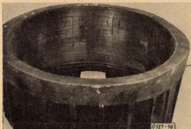
1a—b ábra. Öntöttvas tehergépkocsi-fékdob tartós üzemi használat után a) fékdob, b) fékfelület
