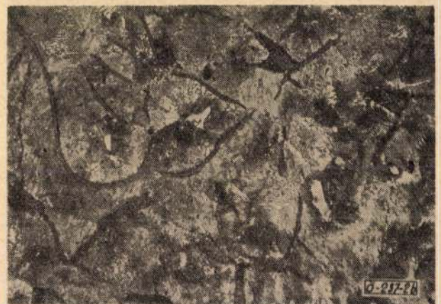
2. ábra. Az öntöttvas szövetének változása antimon hatására. 4%-os pikrinsavval maratra. N = 300 \times a) 0,002% Sb; b) 0,05% Sb
