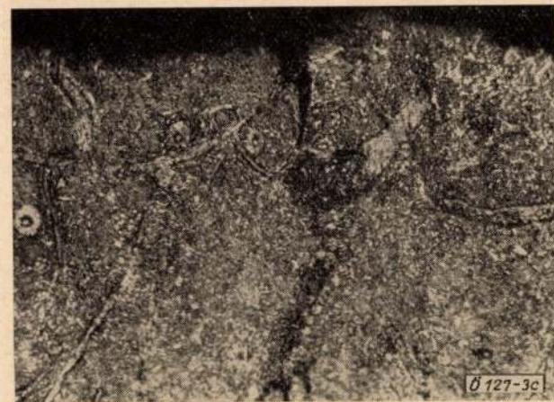
3a—c ábra. Tehergépkocsi-fékdobok fékfelületi szövete 25 000 km-es kísérleti üzem után
