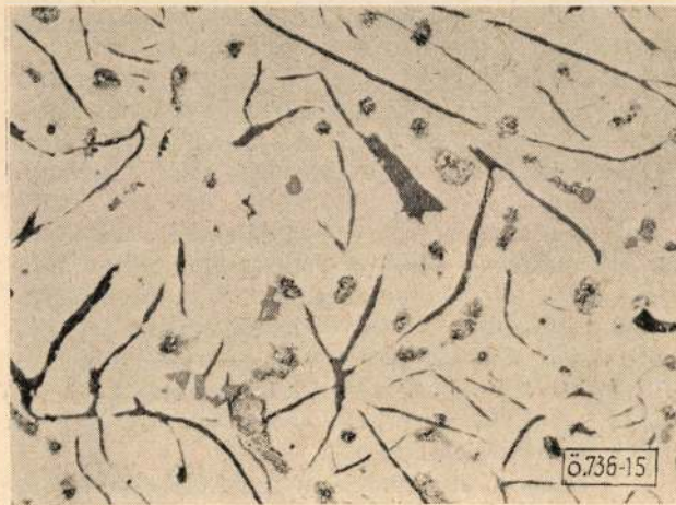
15. ábra. A savanyú fényesítőszőr foltokat hagyott. A képen lemezes grafitot és MnS-zárványt láthatunk. N = 200 \times
