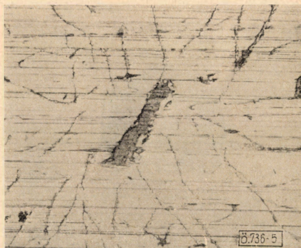
5. ábra. 400-as papíron előkészített felület. Lemezes grafit karcokkal. N = 500 \times
