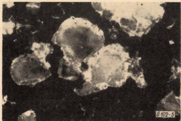
5. ábra. A kisebb szemcsék cseppkőszerűen tapadnak a négyszer izzított bentonitos zománchártyával bevont kvarcszemcsékhez. Polarizált fény. N = 140 \times
