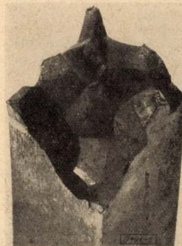
2. ábra. Durvaszemcsés törési felület. N = 3 \times
