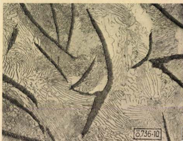
10. ábra. Közel egyenlő nagyságú, rendszertelenül elhelyezkedő lemezes grafit, lemezes perlit. Maratás 1%-os alk. salétromsavban. N = 500 \times
