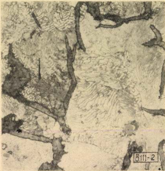
2. ábra. Durvalemezes grafit homoköntéssel készített bugában. N = 500 ×; 2% HNO 3
