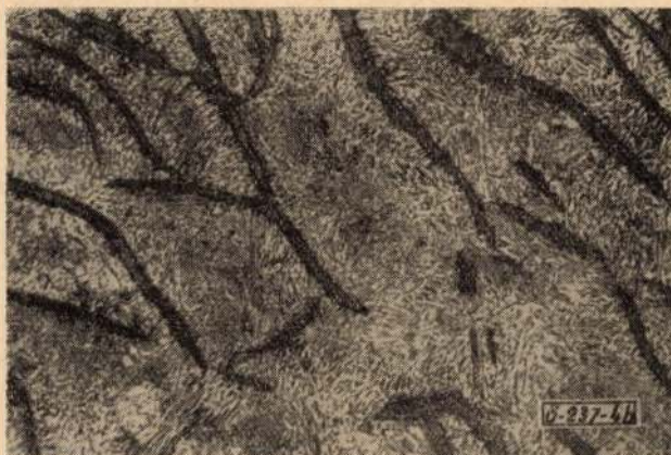
4. ábra. Az öntöttvas szövete 700^\circ\text{C} -on 4 óráig tartó hőkezelés után
