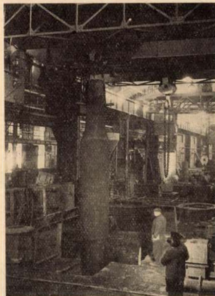
54. ábra. Kéreghenger kiemelése az öntőgödörből. Diósgyőr, 1967.
