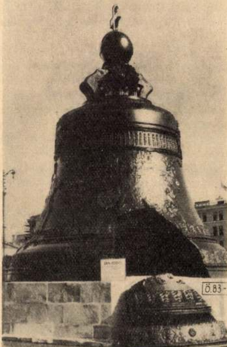
1. ábra. A „cár kolokol” és a kiemelése közben, a harang testéről levált kb. 11 t súlyú töredék
