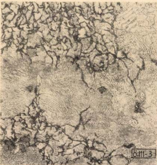
3. ábra. Finom eutektikus grafiteloszlás, finom perlitel, folyamatos öntéssel készült hengeres bugában. N = 500 ×; 2% HNO 3
