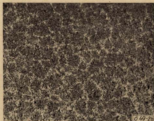
2. ábra. Eutektikus cellák az ónt tartalmazó öntöttvasban: a — 0,1% Sn; b — 0,5% Sn-tartalom esetén 10%-os alkoholos \text{HNO}_3 -mal maratva. N = 15 \times
