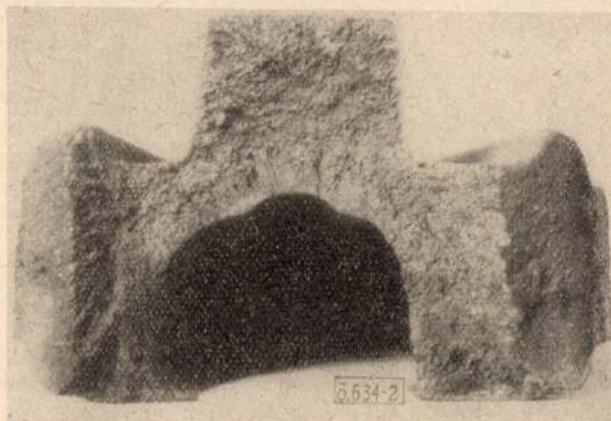
2. ábra. Hőkezeltnek tartott csúcsbetétöntvény egyengetésekor eltört szelvénye
