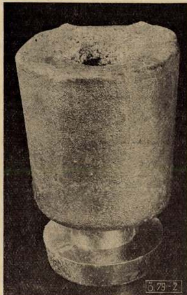
2. ábra. Fajsúlyhányados próba fényképe.
