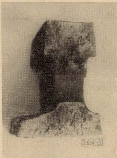
3. ábra. Hadfield-acélból öntött vasúti váltóalkatrész egyengetéskor eltört szelvénye
