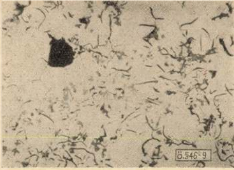
9. ábra. Gázhólyag közelében levő mangánszulfid zárványok
