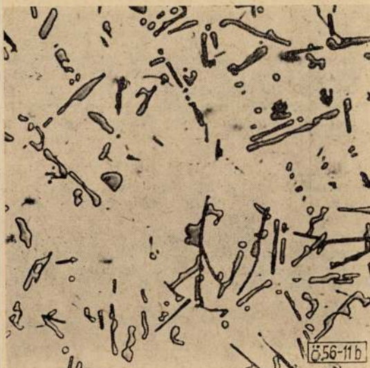
11. ábra. Nemesítetlen AlSi_{10}Mg ötvözet szövete képe hőkezelés előtt (a) és hőkezelés után (b). N=200\times
