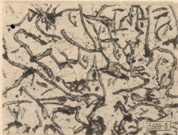
6. ábra. Ívkemencéből öntött ötvözetlen próba szövetképe 650°C-on izzítva, 100 szakasz után. N=300\times
