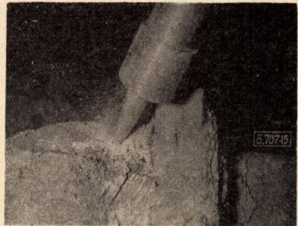
15. ábra. M-típusú elszívófej a porkeltés pillanatában
