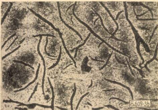
3. ábra. Az ívkemencéből öntött ötvözetlen próba szövetképe
