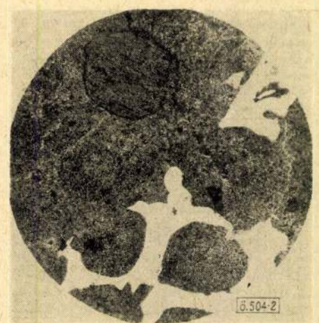
2. ábra. 750°C-on lágyított 1. jelű próba mikrofelvele. N = 100 ×
