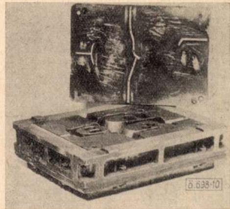
10. ábra. A 9. ábra szerinti magsekrény a levegőző csatornák mintájával
