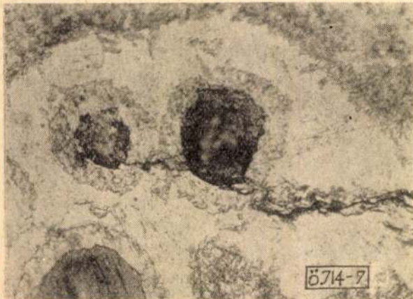
7. ábra. Repedés a felületileg edzett görgő felület alatti rétegében. Maratva. N = 500 \times
