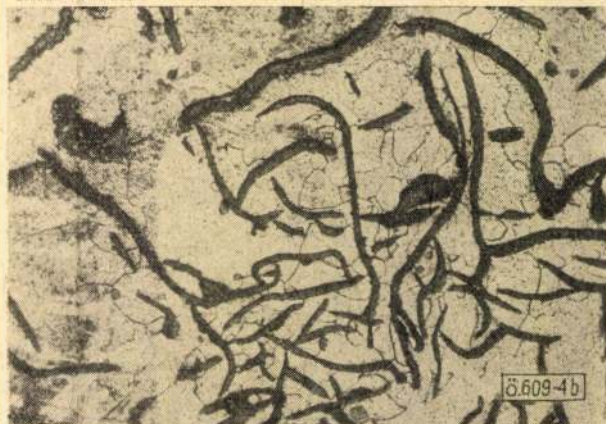
4. ábra. A forró szeles kupulókemencéből öntött ötvözetlen próba szövetképe
