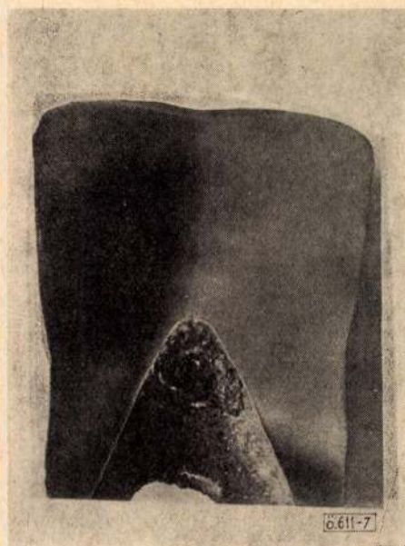
7. ábra. Nedves homokformába öntött kúpos próbatest metszete, a dermedés gázhólyagképződés nélkül történt. N = 2 \times
