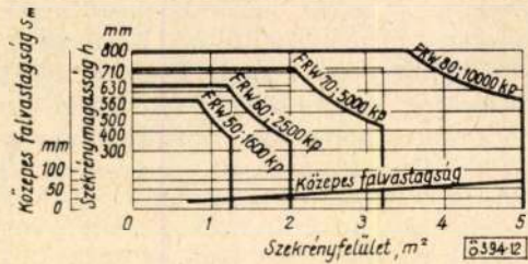
12. ábra. Az FRW -típusú rázó-fordító formázógép-sor egységeinek lépcsőzése
