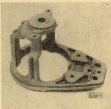
5. ábra. Pajzs. Anyaga: \text{öAlSi12Fe} , súlya: 0,85 kg, előállítva 900-as Polák-gépen
