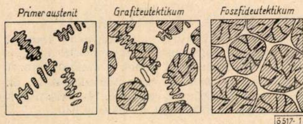
1. ábra. Hipoeutektikus öntöttvas kristályosodása vázlatosan [1]
