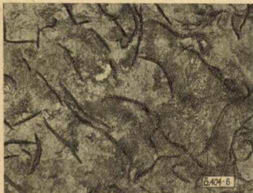
6. ábra. Ny 14 jelű (30 mm átmérőjű) próba szövete. 300×. 5% alk. HNO 3
