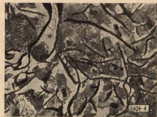
4. ábra. Au 4 jelű nyersvas szövetképe. 300×. 5% alk. HNO 3
