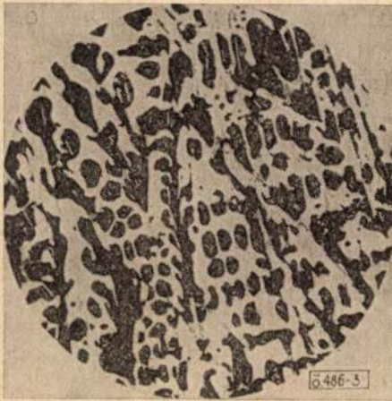
3. ábra. A kéregrész szövete. N = 100 \times
