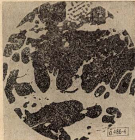
4. ábra. Az átmeneti rész szövete. N = 100 \times
