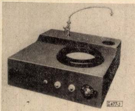
3. ábra. Asztali gép próbatestek nedves csiszolására (WIRTZ)
