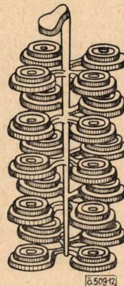
12. ábra. Emeletes forma a penetrálás vizsgálatára. A változó itt az öntési magasság
