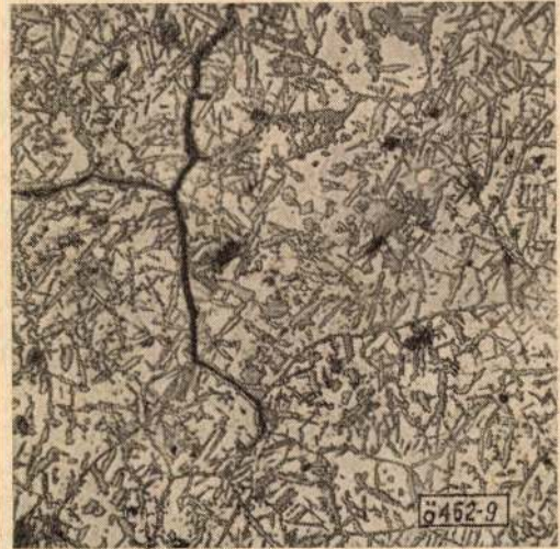
9. ábra. Austenit -esített, vízben edzett, majd néhány órán át 600^\circ\text{C} -on tartott mangánacél-próba szövete (alk. \text{HNO}_3 ; nagyítás 100-szoros)
