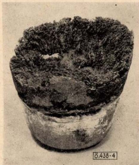
4. ábra. Alumínium-titán reakciótermék
