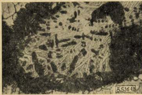
12. ábra. A hegesztett cső varratának mikrocsozilata (alk. HNO_3 -mal maratva, N = 450 \times )
