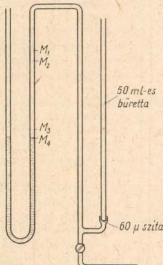
1. ábra. A homok tényleges fajlagos felülete meghatározására szolgáló készülék [2]
