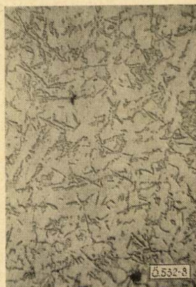
8. ábra. 4. kísérlet metallográfiai felvétele, 100× nagyítás
