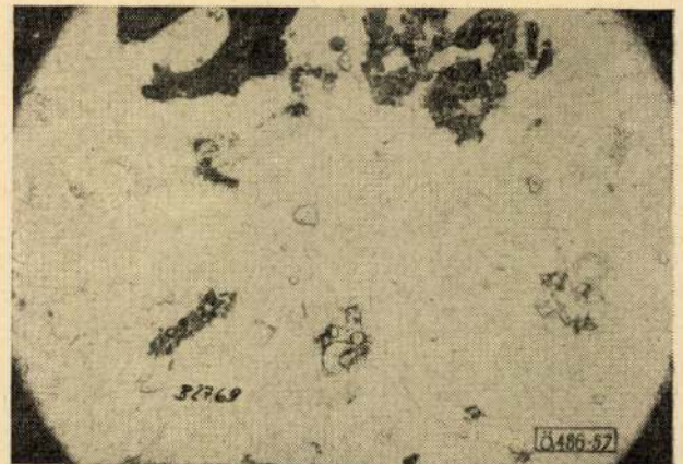
57. ábra. Oxidos zárványok nyomásos öntvényben (balra fent korund, jobbra fent spinell). N = 100 \times
