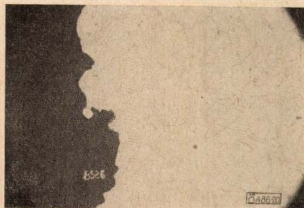
20. ábra. Rétegeképződés G-Al Si 5 Mg ötvözetben. N = 100 \times
