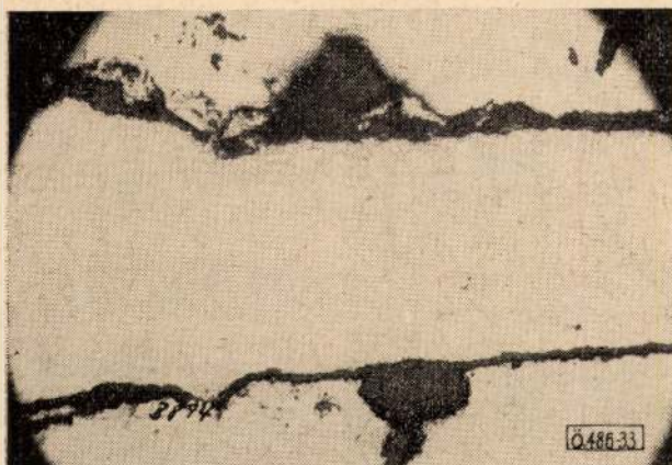
33. ábra. G-Al Si 12 0,5% magnéziumtartalmú ötvözet oxidrétege. N = 100\times
