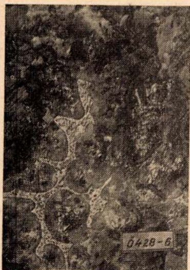
6. ábra. 2 perces \text{NH}_3 -kezelés hatása a szövetre 300 ×
