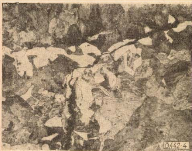
4. ábra. Részben a ferrit-hálót, részben a perlit-csomók határait követő repedés Cr 100 minőségű, kagylós törésű tuskóban. N = 150 \times
