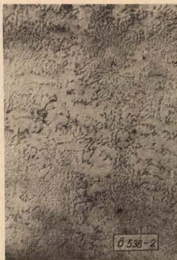
2. ábra. Duszil-ötvözet nemesítő hevítés nélkül 230 C°-on megeresztve, N = 100 ×
