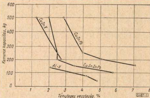
1. ábra. A kemencekapacitás hatása a tényleges veszteségre egyszeri olvasztáskor, x = ötvözőfém
