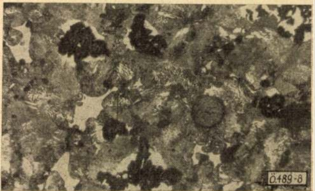
8. ábra. A D27 adagszámú forgattyústengely szövete N = 1 : 250. Maratva 2% HNO 3
