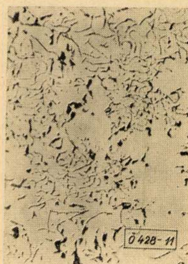
11. ábra. 4 perces \text{N}_2 -kezelés hatása a grafitra 100 ×
