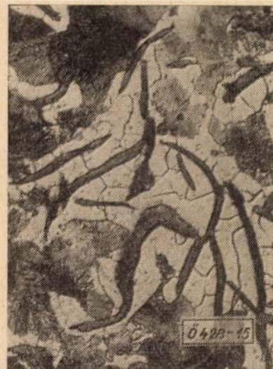
15. ábra. 4 perces N_2 -kezelés hatása a szövetre 300\times
