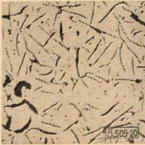
20. ábra. Kokillában gyártott VL-2416 jelű dugattyú grafitja hegesztett állapotban N = 100 ×
