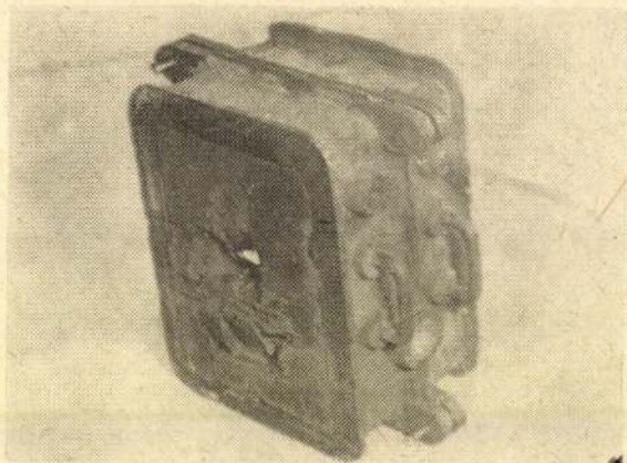
6b ábra. A forma helyzete dermedés közben
