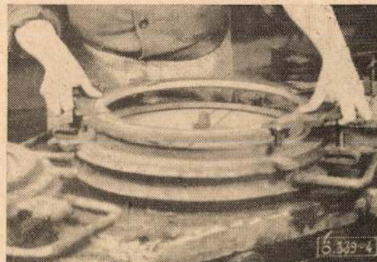
4. ábra. A mag kinyomása, ill. a keret levétele a formáról
