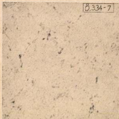
7. ábra. Cu-Al 7,5 Ti 1 ötvözet 750 °C-on 26 óráig homogenizálva és vízben edzve 600 ×
