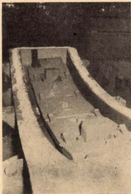
12. ábra. Kiegyenlítő súly alsó kokillája, 2 db átnyúló maggal, előre öntött betétekkel
