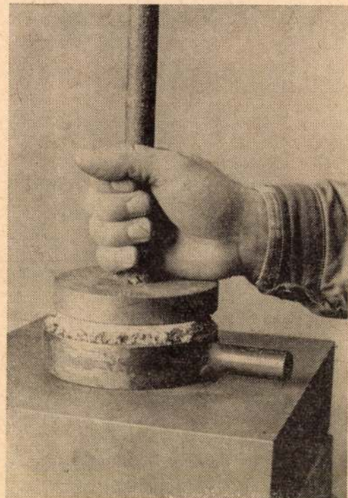
11. ábra. Próbatest zömítése lapos döngölővel
