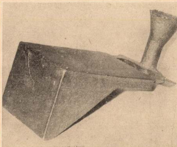
25. ábra. Szódamentes mintahomokba formázott sarok-próba
