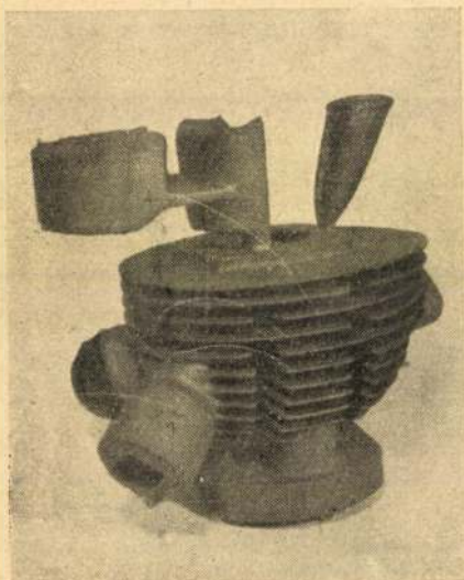
3. ábra. 250 cm 3 -es motorkerékpár-henger új öntési helyzete
