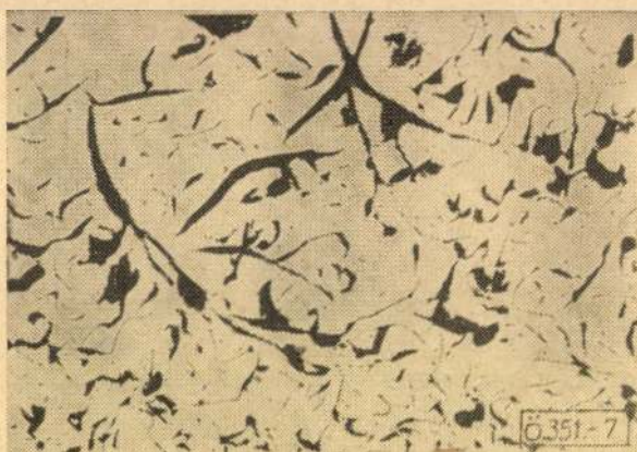
7. ábra. Grafiteloszlás a 3. ábrán bemutatott nyersvasötret „a” pontján ( N = 100 \times )
