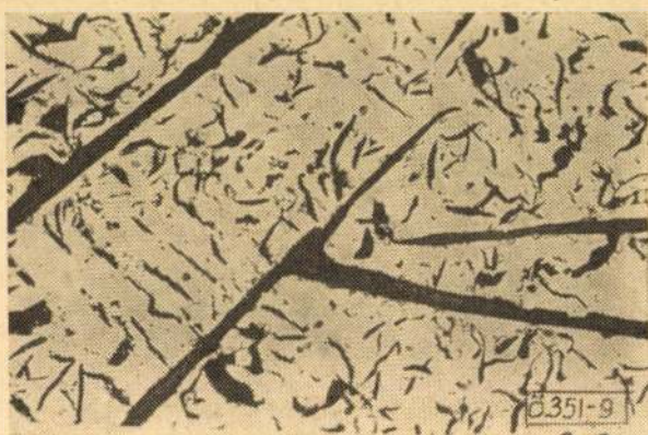
9. ábra. Grafiteloszlás a 4. ábrán bemutatott nyersvasötret „k” pontján ( N = 100 \times )
