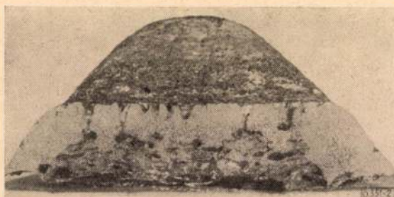
2. ábra. Dunai Vasmű nyersvasának finom töreite, öntési hibával
