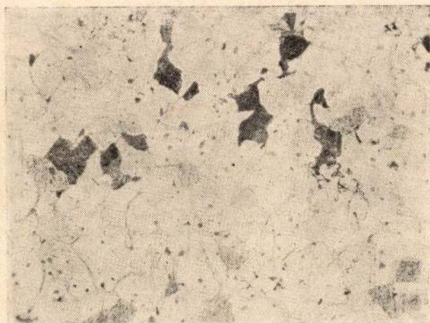
14. ábra. Széntelenített fittingek szövetszerkezete 300×, a VI. kísérletből
