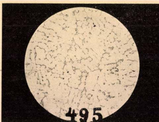
13. ábra. Könnyűfém kokillában öntött próba mikrociszolata. N = 150 \times
