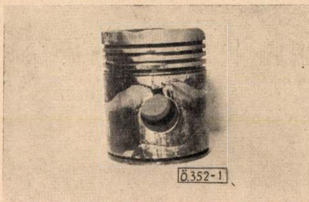
I. ábra. Repedt dugattyú
