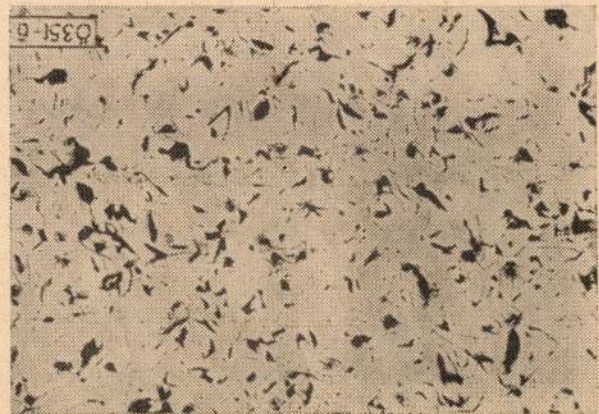
6. ábra. Grafiteloszlás a 3. ábrán bemutatott nyersvas-töret „k” pontján ( N = 100 \times )
