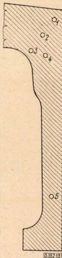
15. ábra. A' dugattyúnak szinképelemzéssel vizsgált pontjai
