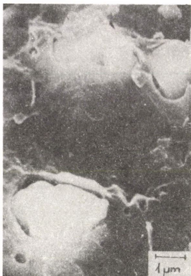
6. ábra. Nagykomponensű rendszer törésfelülete szelektív maratás után (az üregek az elasztomer helyét jelzik). A töltőanyag : elasztomer arány 6 : 1
