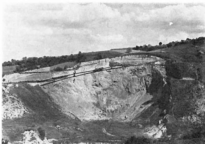
43. ábra. A váraljai cigánysoron levő nagy dolomitfejtő. — 1. Másodlagos dolomit (anizuszi), 2. kavicsos homok (felsőpannon), 3. lösz (pleisztocén) Abb. 43. Grosser Dolomitbruch. Váralja, Cigánysor. — 1. Sekundärer Dolomit (Anis), 2. schottriger Sand (Oberpan- non), 3. Löss (Pleistozän)
