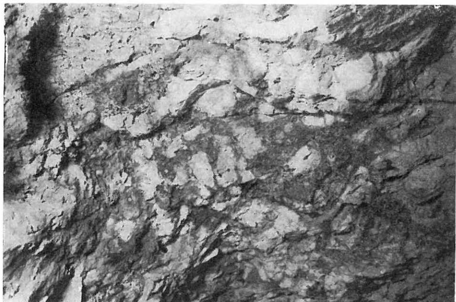
19. ábra. Impregnációs ércesedés, Alsó Rózsatáró, D-i irányvágat Figure 19. Stockwork mineralization, Alsó Rózsa-gallery, southern cut
