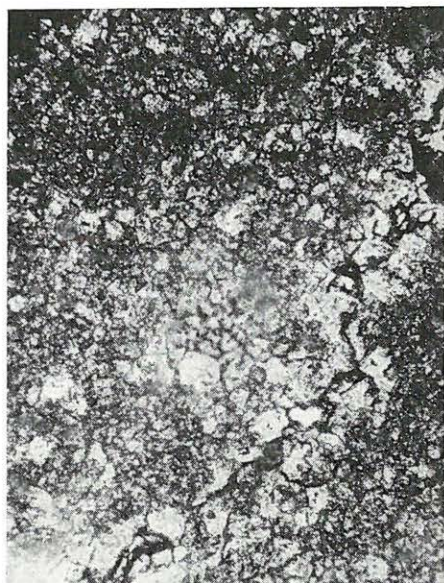
10. ábra. Kissé porló dolomit. Finomszemcsés dolomitkristályok elmosódott határú, durvább kristályos dolomitból álló erekkel. (28. sz. minta, 40\times ; párhuzamos Nikolok.)
