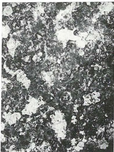
11. ábra. Porló dolomit egyenletesen elosztott kvarc- és kalcedonszemcsékkel. (25. sz. minta, 40\times ; keresztezett Nikolok.)
