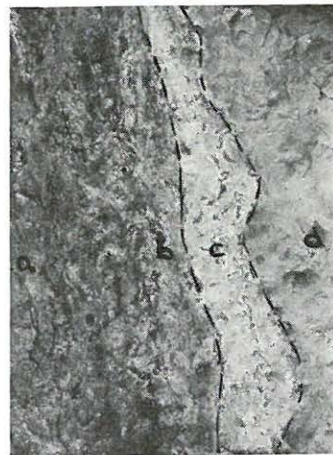
15. ábra. Dolomit és kaolinós agyag érintkezése. a) kissé porlódó dolomit, b) erősen porlódó dolomit, c) hidrargillit-réteg, d) sárga kaolinós agyag. (A természetes nagyság egy tízede.)
