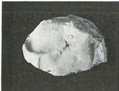
17. ábra. Tömött, vesés halloysit-fészkek a rostos hidrargillitrétegben. (19. sz. minta, term. nagys.)
