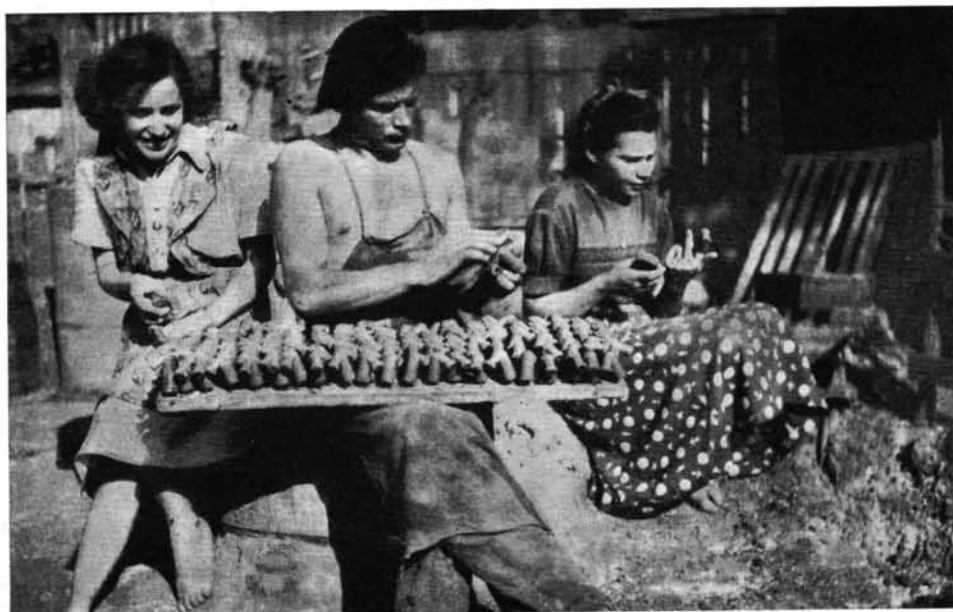
XXVII. t. Nyárády : 1. Pipapucoló. 2. Körvágó. 3. A szeges állón levő nyers pipák szájjigazítása
