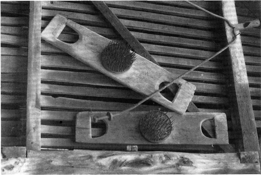
5. Használaton kívül a góré hátuljára aggatott ritkább és sűrűbb fogazású gereben Levendovics György udvarán.
