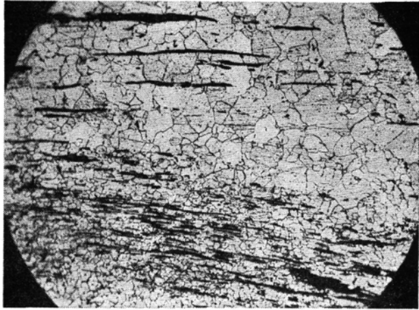
5. ábra. Buca-vas mikroszkópi képe. 100x
