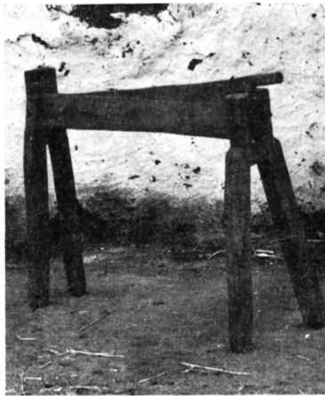
2. kép. Deszkás szerkezetű tiló, Kurittyán
