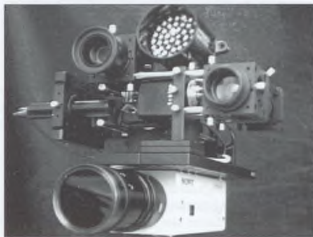
7. ábra. LABrador fedélzeti helymeghatározó műszer kísérleti kivitelben
