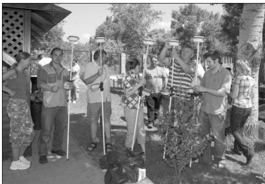
2. ábra GPS mérőfelszerelés takarító eszközök felhasználásával
