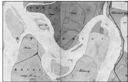
2. ábra A mederábrázolás pontossága Gator község közelében. A szelvények határánál nem törik meg a partvonal futása.
