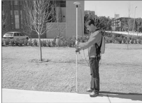
4. ábra RTK a legpontosabb navigációs technika
