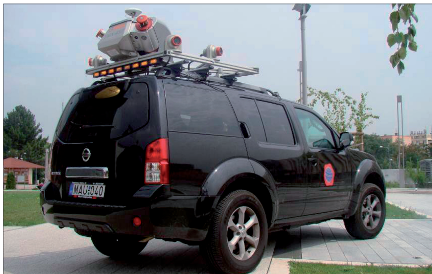
1. ábra. A Geodézia Zrt. Mobil Térképező Rendszere a hordozó járműre szerelve
