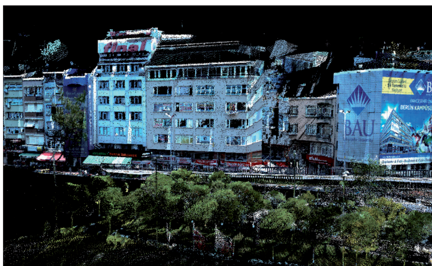
7. ábra. Digitális kamerák képei alapján színezett lézerpont-felhő
