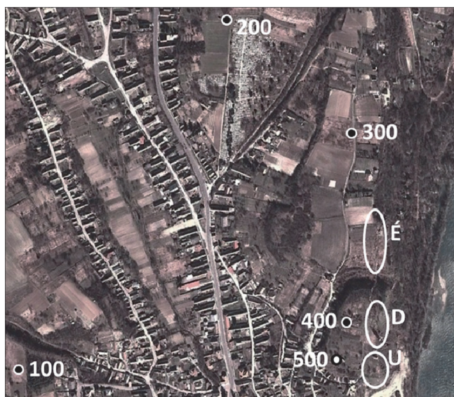
1. ábra. A geodéziai hálózat vasbeton mérőpillérei (100–500), az ellipszisek az északi (É), a déli (D) és az új (U) hálózatrészeket jelölik. Az ábra a Google térkép felhasználásával készült.
