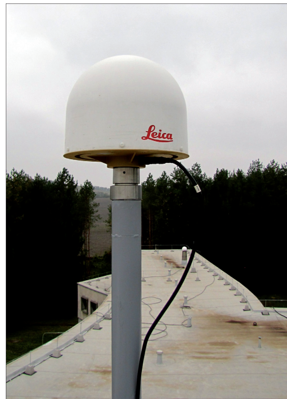
1. ábra. Az új (PEN2), Galileo-jelek vételére képes referenciaállomás antennája (háttérben látható PENC állomás pillére)
