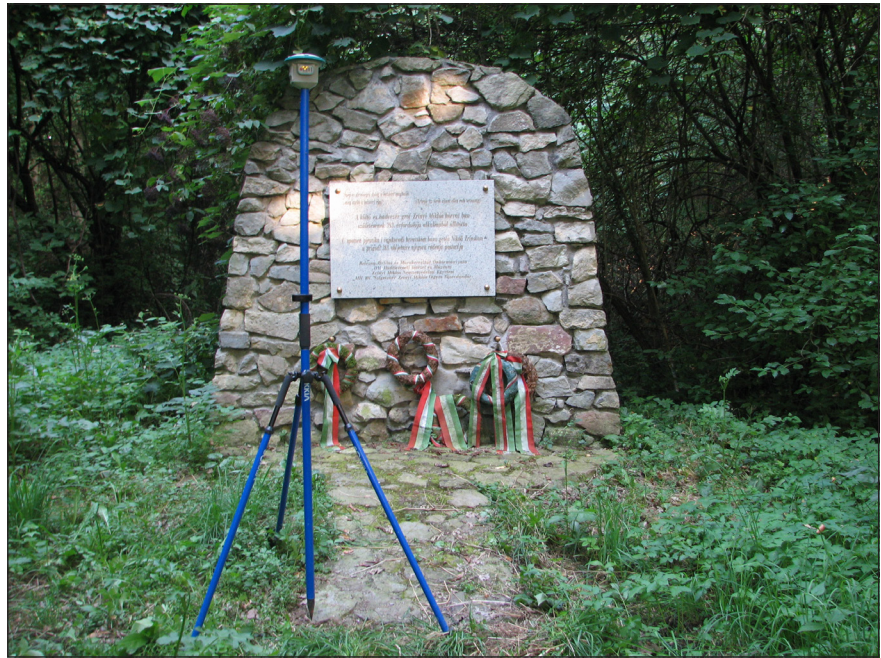
5. ábra: A sokszögvonatok merevítéséhez – ahol lehetett – kiegészítő DGPS-méréseket végeztünk
