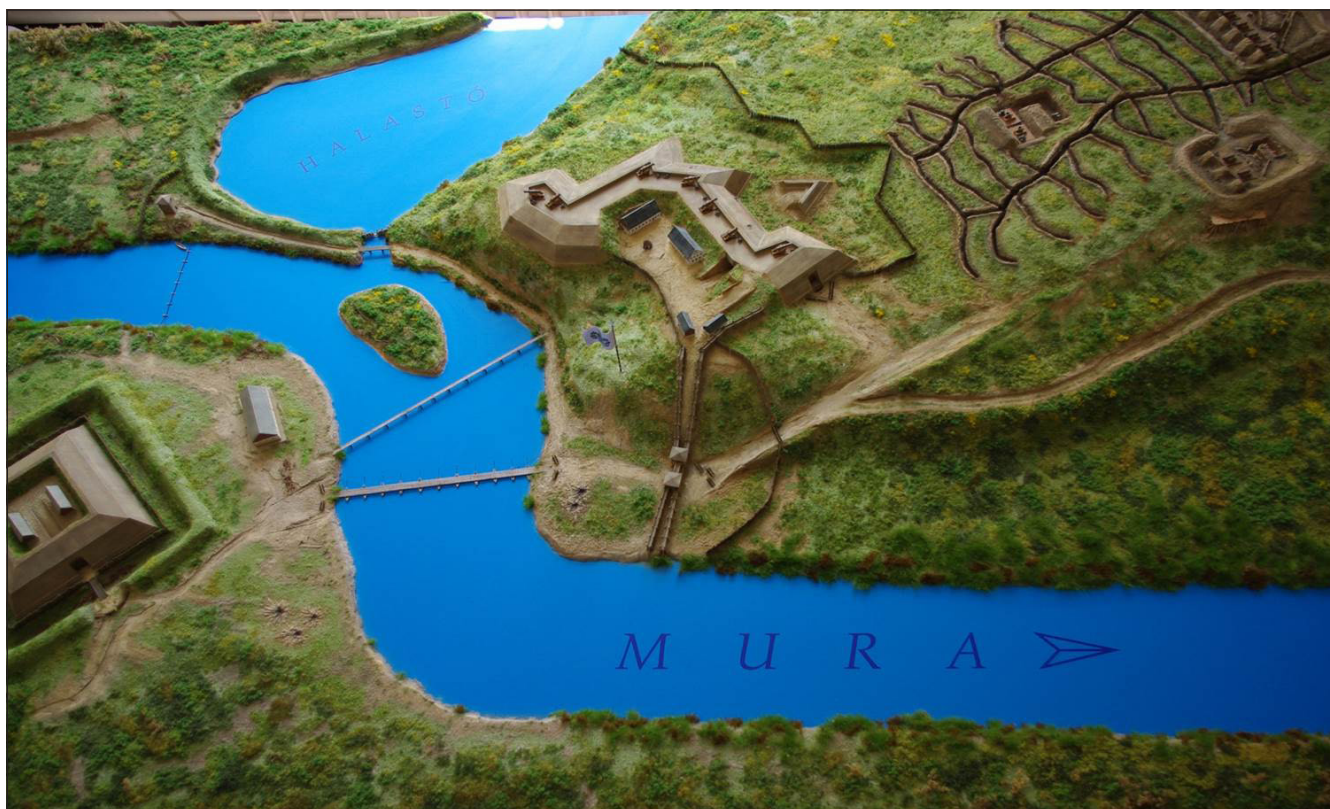
6. ábra: A terepi felmérési eredmények és a hadtörténeti kutatások alapján készült 1:400 méretarányú terepmakett a várról és környezetéről
