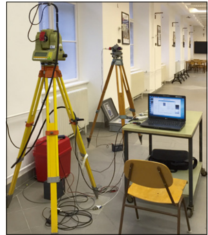
4. ábra. Az ATK-2 kollimátor és a kollimátoros kalibrálás laboratóriumi testje
