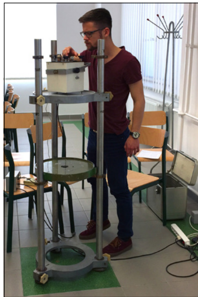
13. ábra. 3 pontos VG mérés az Oltay-féle főalapponton
