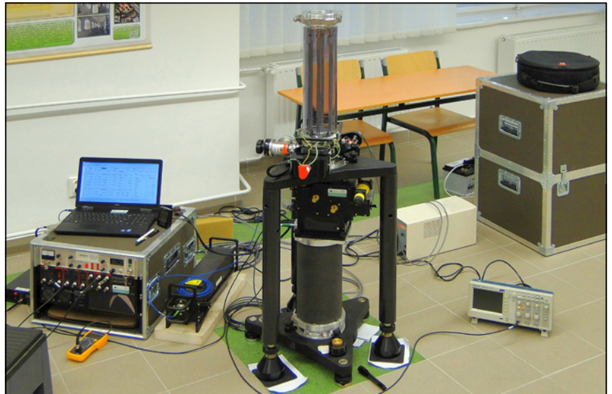
11. ábra. Mérés az FG5X-251 típusú abszolút graviméterrel az Oltay-féle főalapponton
