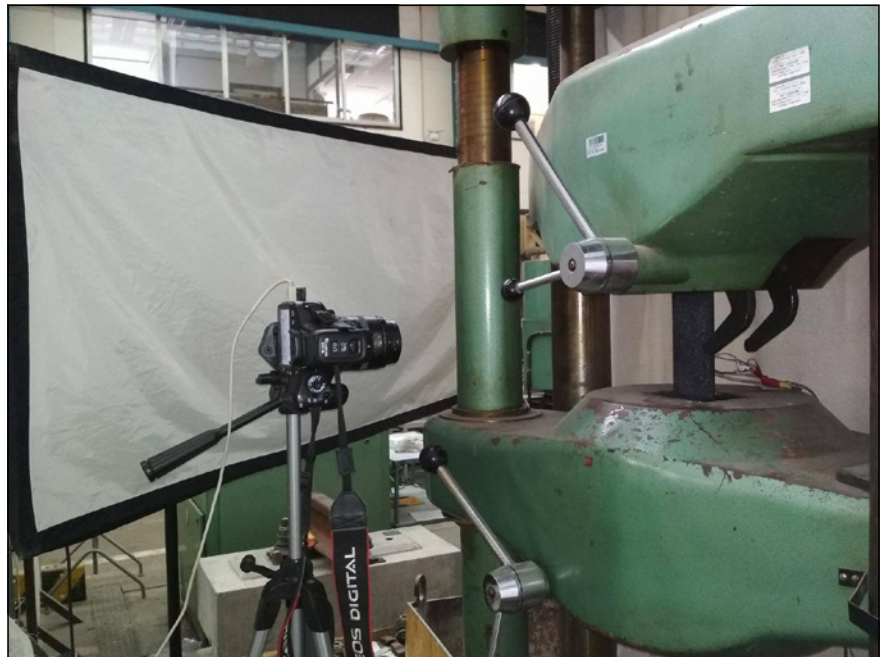
3. ábra. Képkorrelációs vizsgálat kísérleti elrendezése
