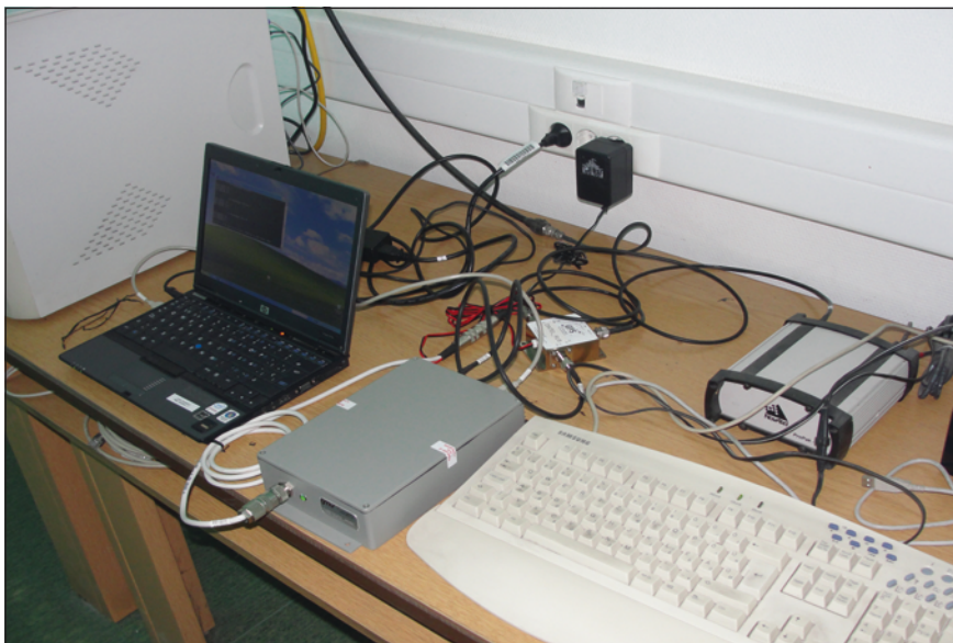
7. ábra. Antennamegosztó, DINTEL-spektrumanalizátor, és GPS-vevő
