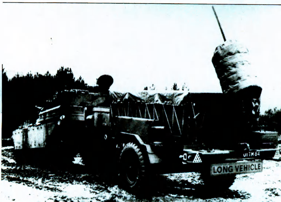
21.-sz. ábra: GIANT VIPER reaktív átjárónyitó
