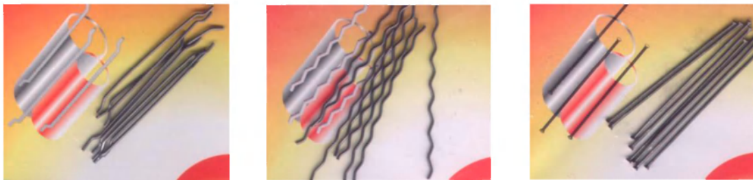
2. ábra: Acélszálak jellemző kialakítása
