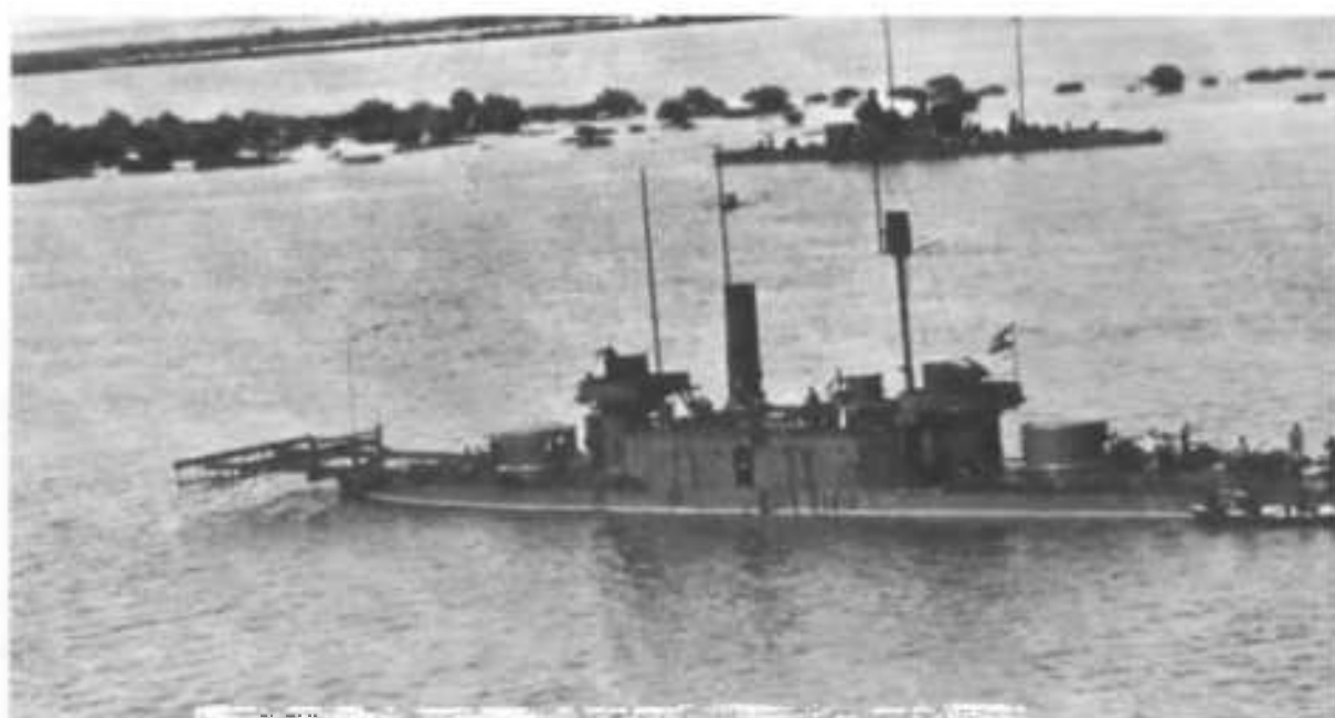
24. ábra A KŐRÖS valahol az Al-Dunán, háttérben az ENNS-szel. A KŐRÖS orrán lévő szerkezet az úszó áknak kifogására szolgált
