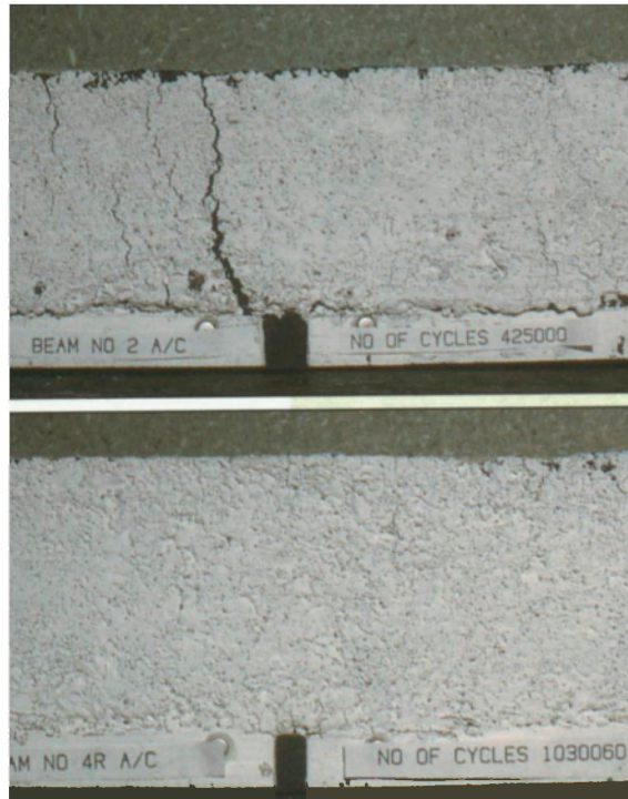
13. ábra: Aszfaltrétegek georács nélkül és georács erősítéssel
