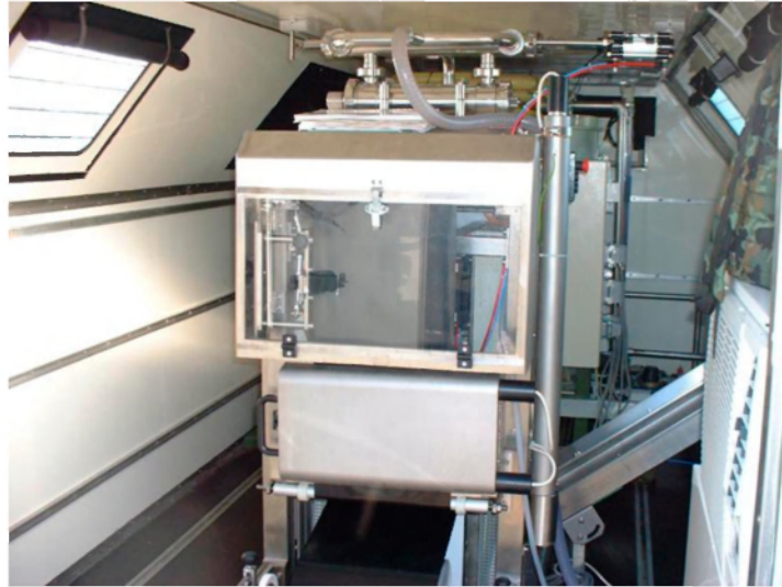
7. ábra 10 : Tömlőtasakos csomagoló berendezés
