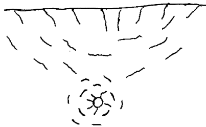
1. ábra. Az anyag tönkremenetele a robbantás hatására Thum szerint
