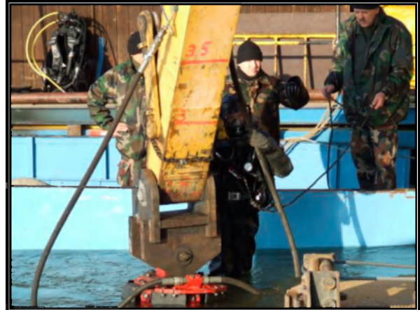
7. ábra: A sodrás miatt a gémhez rögzített tűzszerész bűvár 8
