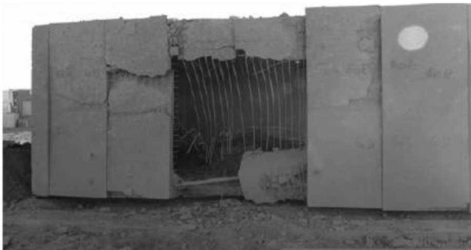
1. ábra: 6000 kg TNT egyenértékű robbanóanyag okozta repedés
