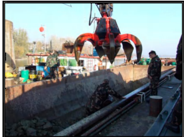
9. ábra: A kotrógép a mellette álló uszályra helyezi a robbanó eszközt 10
