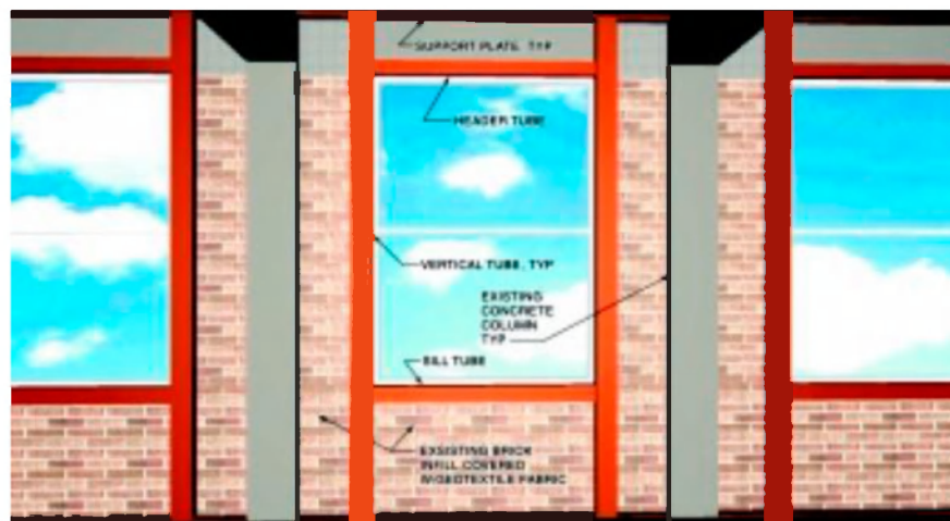
8. ábra: Kihorgonyzott szerkezetek kialakítása
