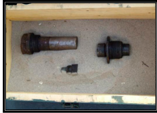
5. ábra: Egy 62 év után hatástalanított GP 500-as ép gyújtószerkezetei 6
