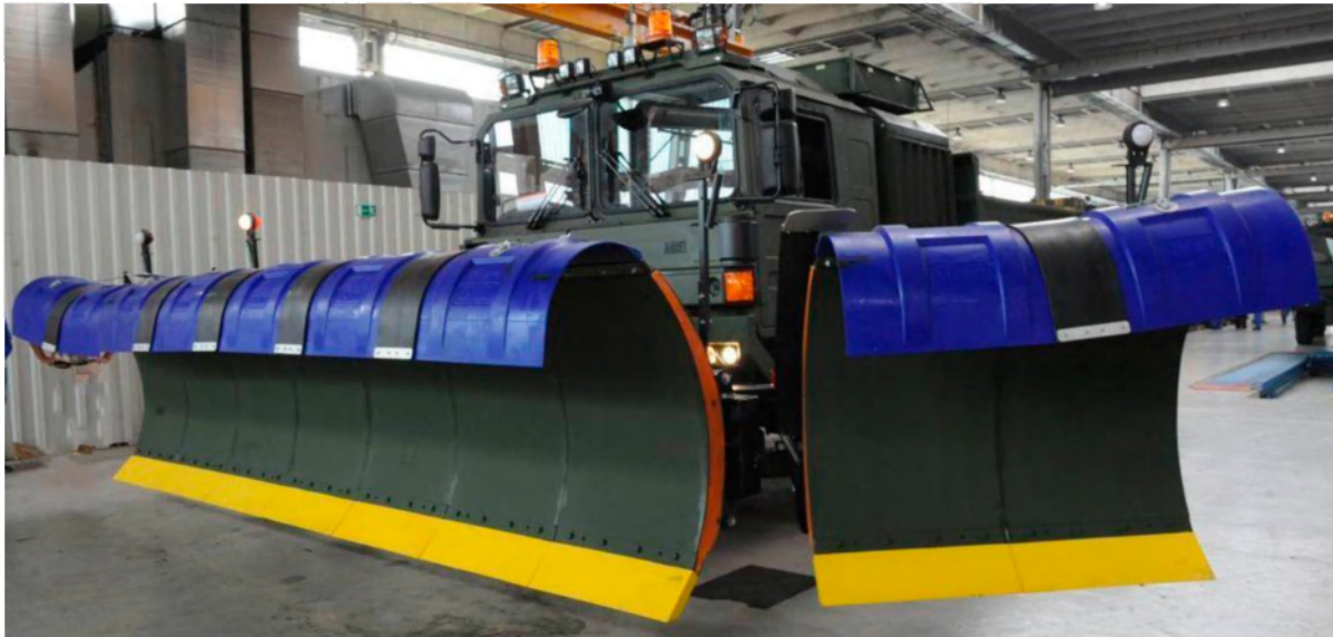
10. sz. kép Behajtott szélső ekelap-szegmens [4]
