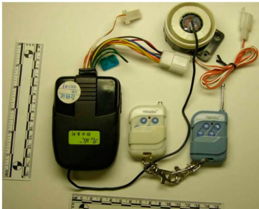
9. ábra. Gépkocsi riasztóberendezés, mint RCIED indító [2]
