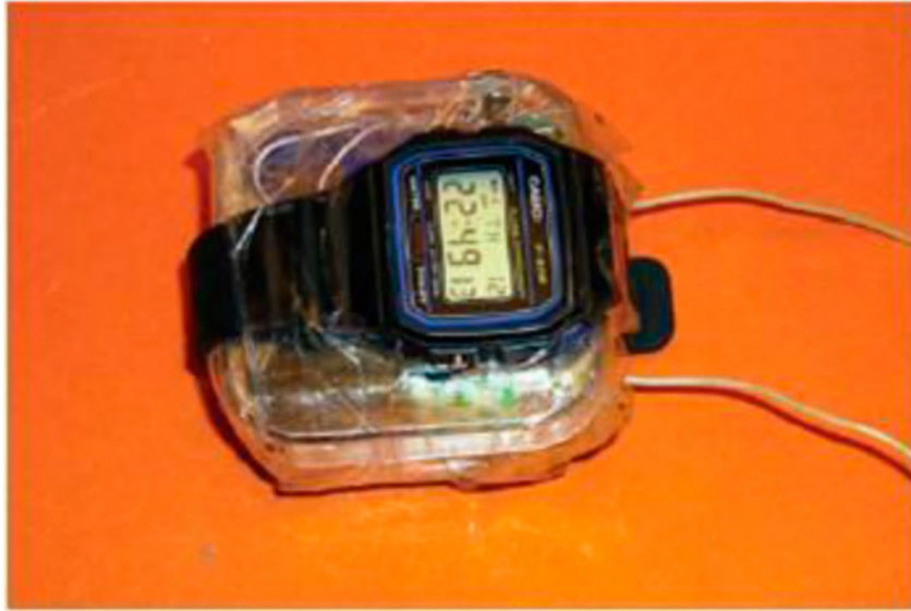
6. ábra. Karóra alkalmazása időzítő kapcsolóként [2]
