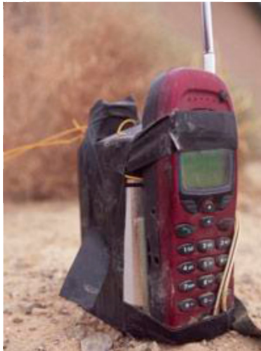
10. ábra. Mobiltelefon, mint RCIED vevőegység [3]
