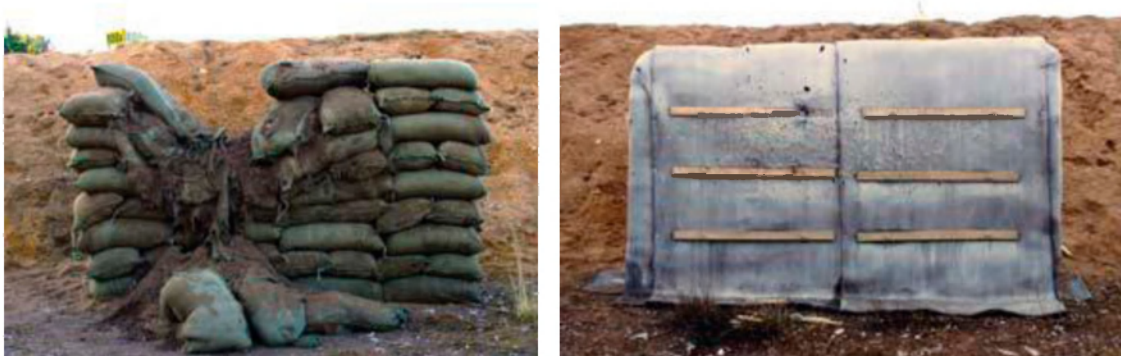
3. ábra: A beton-vászonnal takart lőállás tesztje
