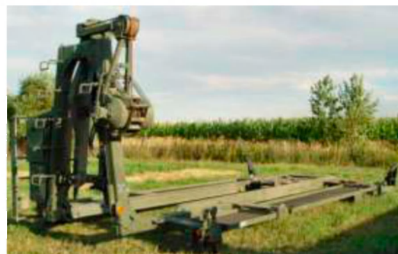
23. sz. kép M15 (BAP) Szabványos pontonmálházó keret 39
