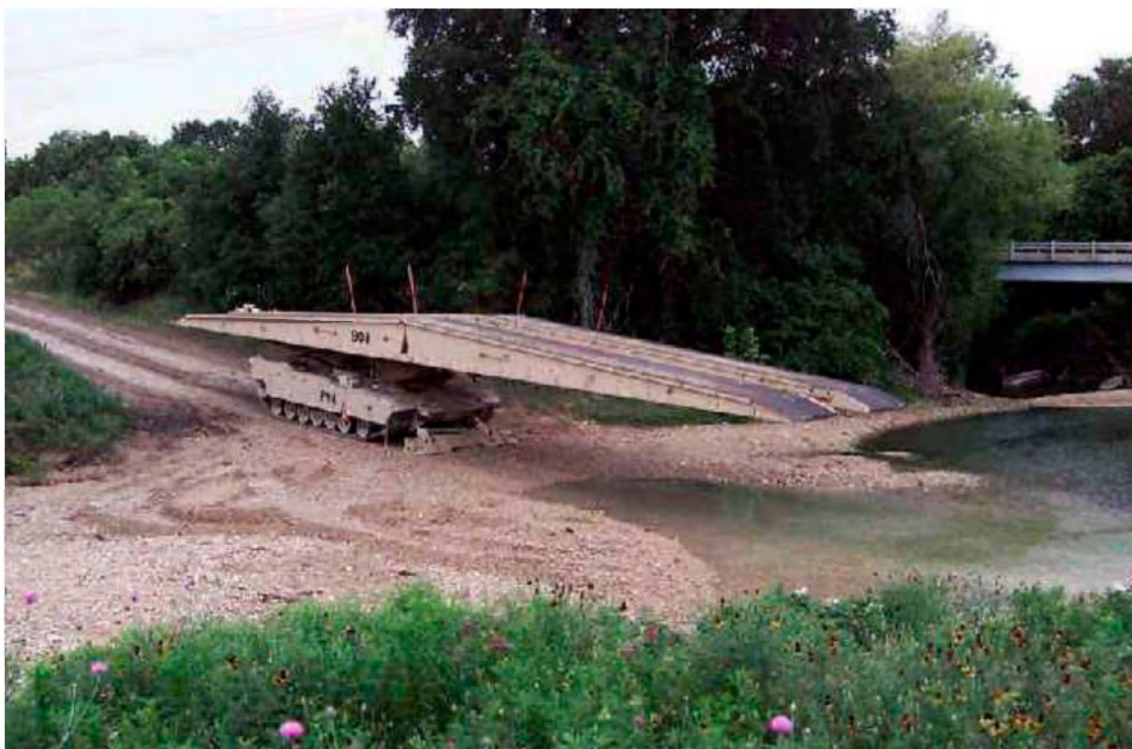
9. sz. kép A híd betolása az akadály fölé 19
