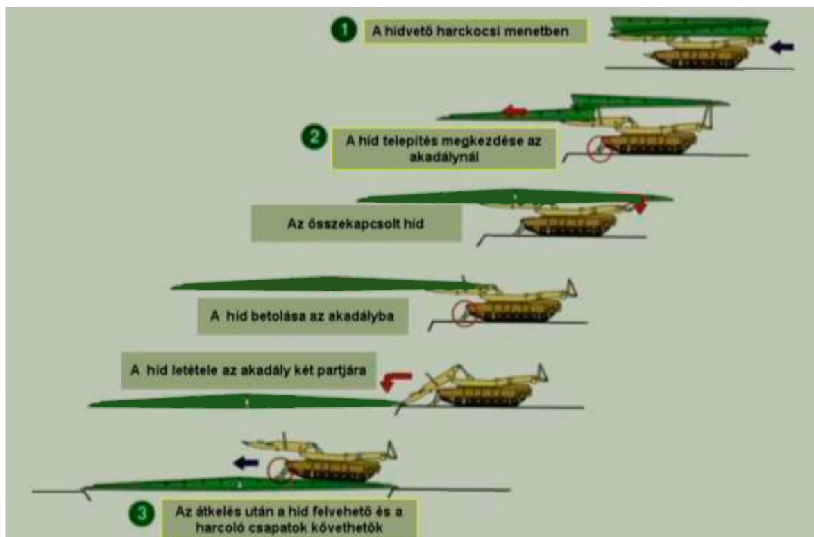
1. sz. ábra A híd telepítésének mozzanatai 18
