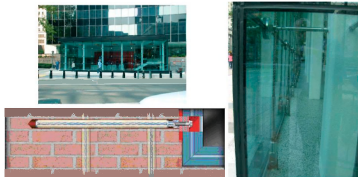
3.5.1 kép: Ablakkeret horgonnyal való falhoz rögzítése 22
