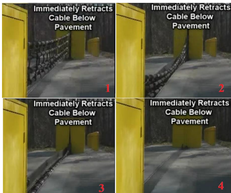
21. kép: Hálórendszer őrzött állapotból őrizetlen állapotba váltásának folyamata 21
