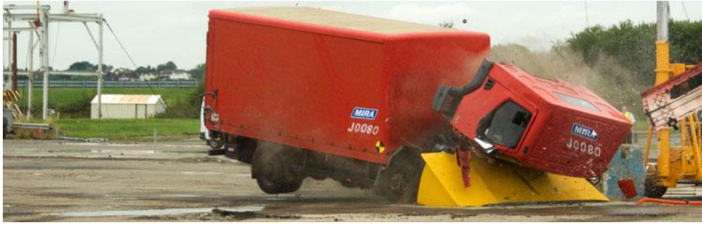
18. kép Ütközés során az útzár felett átbukó pilótafülke 18
