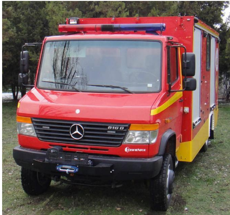
1. kép Mercedes Vario 816 DA alvázra felépített KML jármű 4
