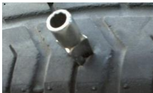
7. kép Kiszakadt tüske a légnymást fokozatosan csökkentő furattal 8
