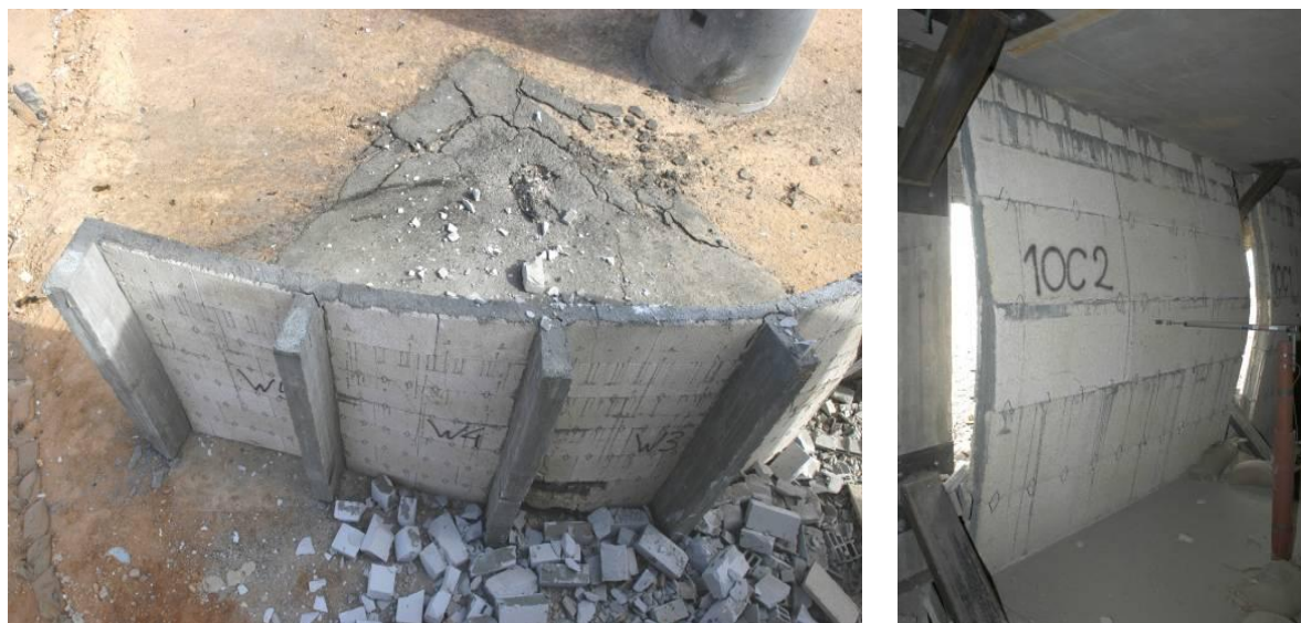
5. ábra. Merevítő bordákkal megerősített, valamint blokkos falszerkezetek 12
