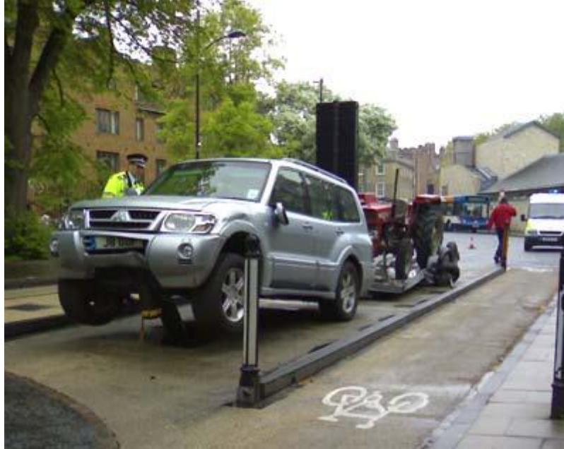
6. Kép: Aktív járműakadályon felakadt jármű 9
