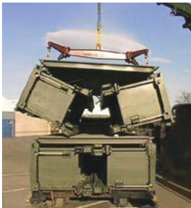
7. sz. kép Az összecukható hossztartók és a fedélzeti elem 24
