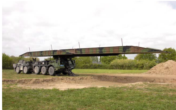
12. sz. kép A két hídmező telepítése 32
