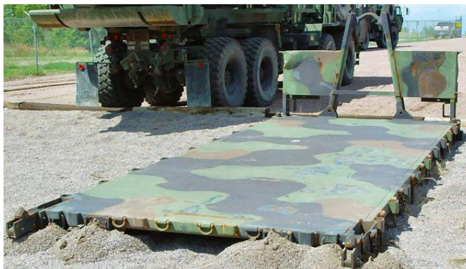
13. sz. kép M1077 PLS (Flatrack) típusú „síkágyas” raklap 37
