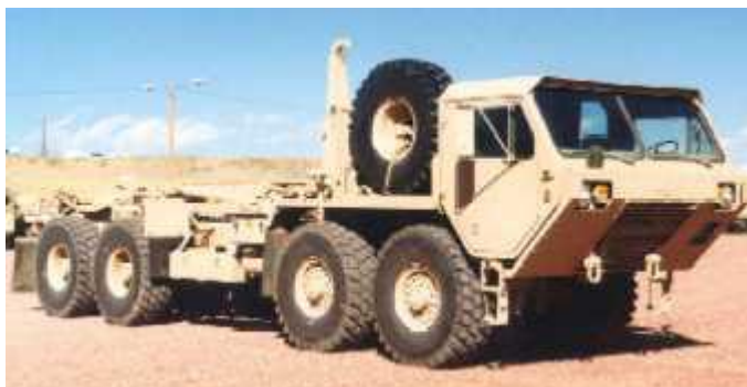
11. sz. kép A hordozójármű (M1977 Common Bridge Transporter) 35
