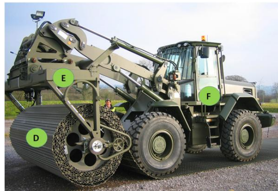
D – útpálya; E – BEACH DISPENSER útpálya telepítő szerkezet; F – hordozójármű
