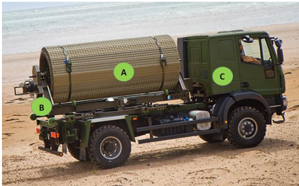
A – útpálya; B – FASTRACK telepítő keret; C – hordozójármű
