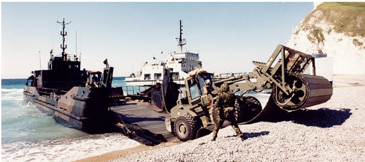
Az MLC 30 útpálya telepítése a hídfő megerősítésére 28
