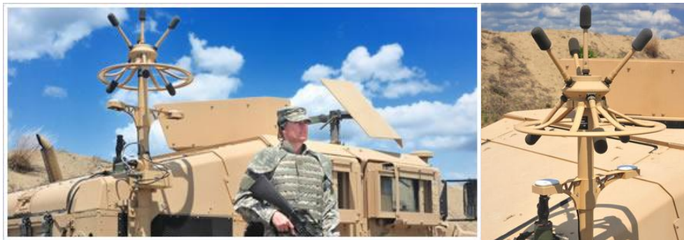
6. Kép: Harcjárműre szerelt akusztikus felderítő eszköz („Boomerang” rendszer) 14
