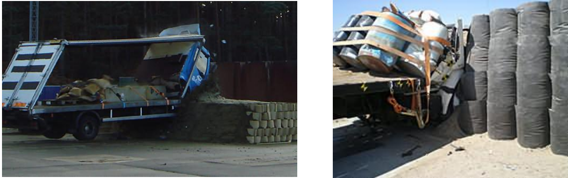
3. ábra. DEFENCELL elemek tesztelése járművekkel [4]
