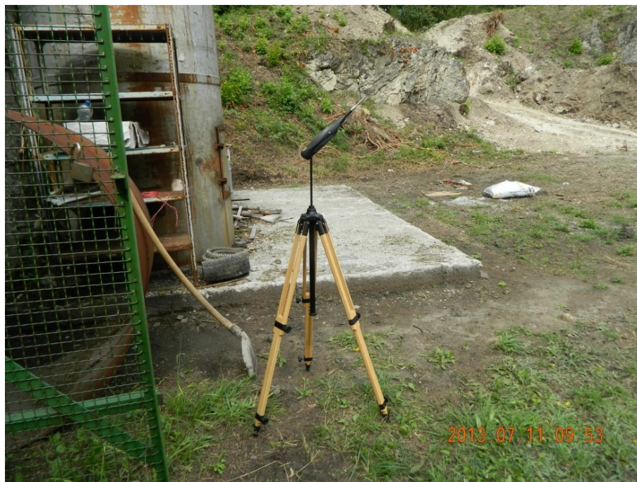
6. sz. ábra: Drager Multi Pid többcsatornás gázmérő
