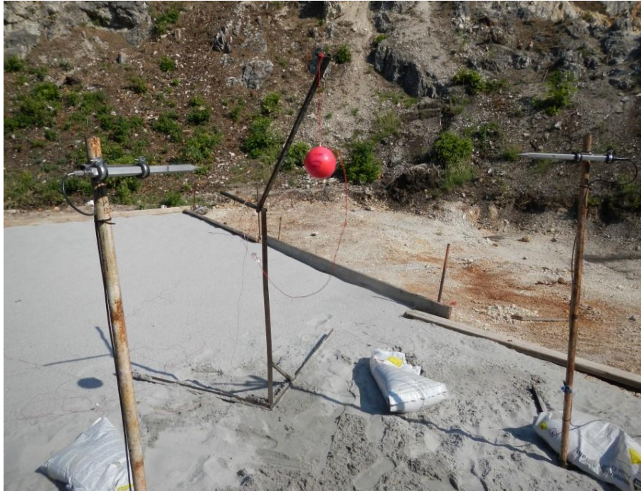
4. sz. ábra: A töltetek a külső nyomásmérő szondákkal 10
