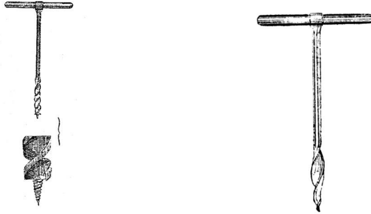
2. számú ábra: Amerikai csavarfúró és csigafúró
