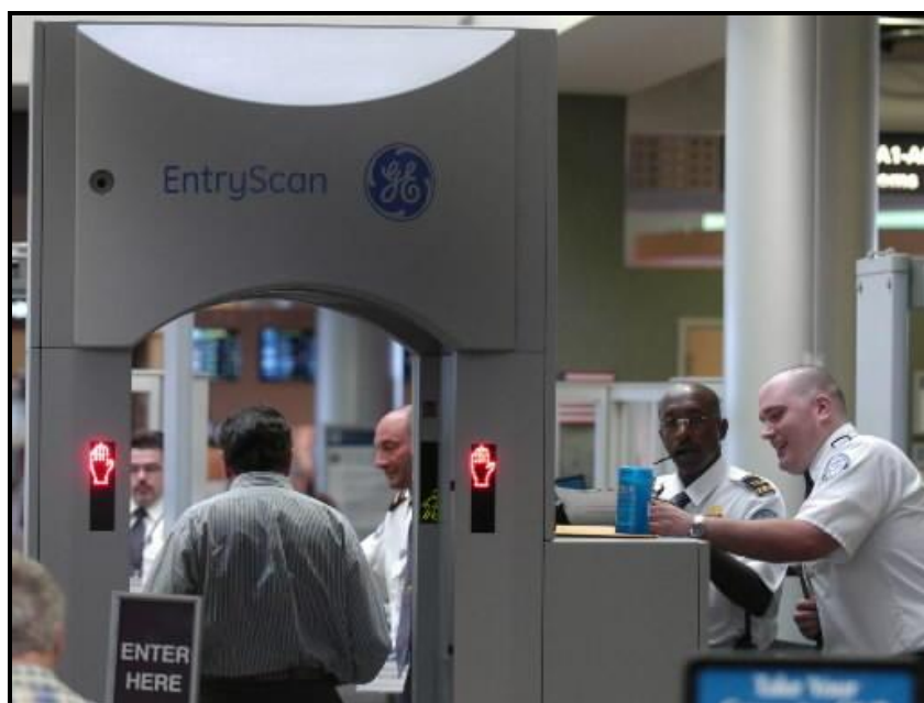
7. ábra Gázkromatográfia és tömeg-spektrometria elvén működő biztonsági beléptető kapu amerikai repülőtéren 9
