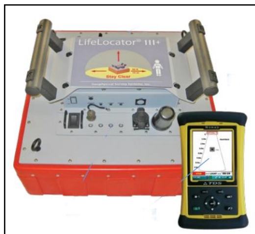
9. ábra Keresőradar adóegysége és a jel megjelenítésére szolgáló PDA eszköz 12
