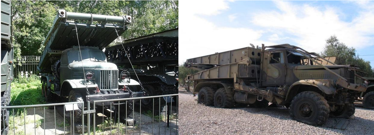
1. sz. kép – KMM–2 13 és egy TMM–3 14 hidrakó jármű
