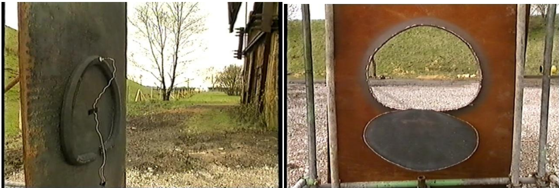
17. számú ábra: Precíziós vágás BLADE lineáris vágótöltettel 86
