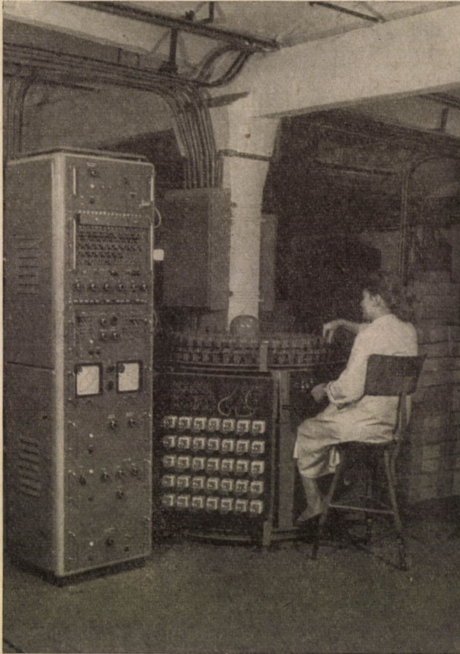
3. ábra. Rádiócső mérőautomata és forgó előmelegítő fényképe
