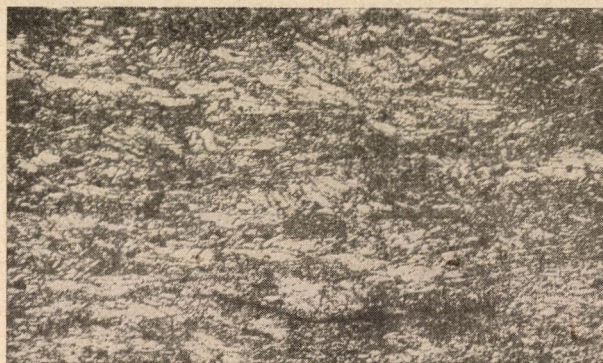
4. ábra. Ütősajtóval készített anódserleg kristályszerkezete ( N = 150\times )
