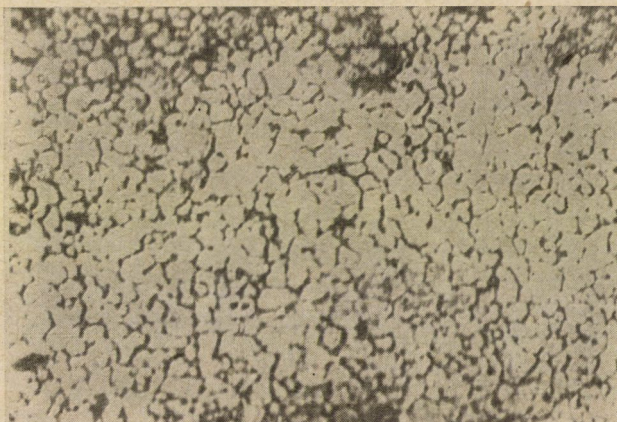
2. ábra. Megfelelő minőségű anódlemez kristályszerkezete megmunkálatlan és hőkezeletlen állapotban ( N = 600\times )
