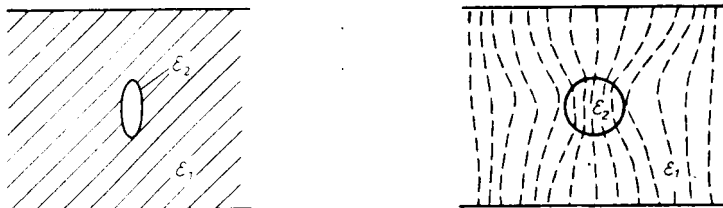
27. ábra. Forgástest alakú inhomogenitások szigetelőanyagban
