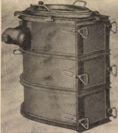
14. ábra. Álló csősablont, alkotóra merőleges irányú vibrátor forgástengellyel
