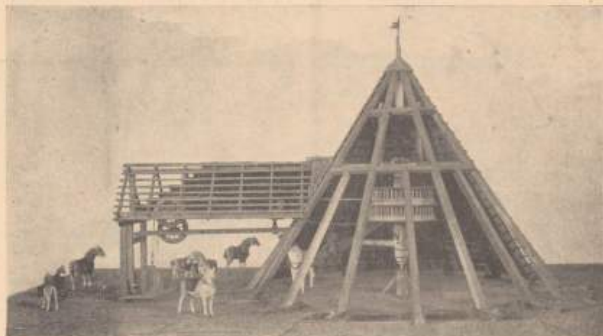
11. ábra. A németországi Zeche Trappe, (Silschede) 1786-ban berendezett járgányának modellje a bochumi Bergbau Museumban. A járgány egy teljes fordulat alatt 10 m-el emelte meg a kőteljén lógó fémhársz basznos terhet befogadó kosokat.
