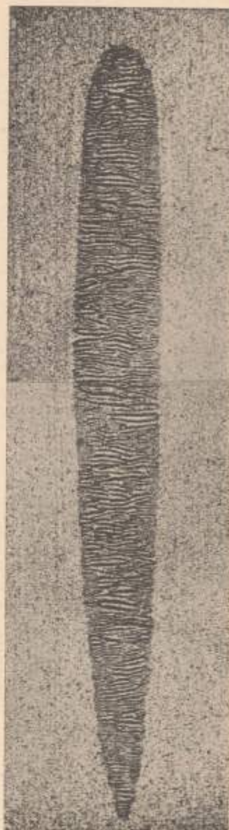
7. sz. ábra. Hőkezelés után keletkezett hólyag.
