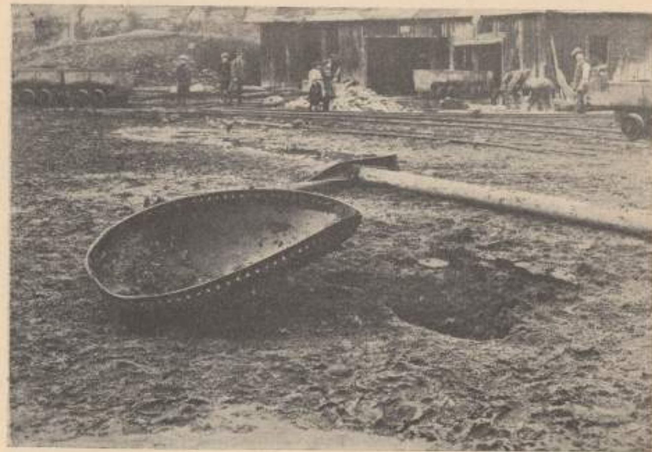
7. kép. A tartány egyik feneke, amely a robbanás helyének közelében a földre esett, miután a jobb oldalon látható gödröt kivájta.
