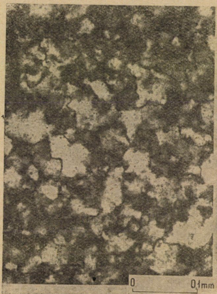
8. ábra. Kvarcit csiszolatának mikrofelvétele
