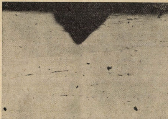
11. ábra. Kezdődő repedés mikroszkópi képe; N = 100 \times
