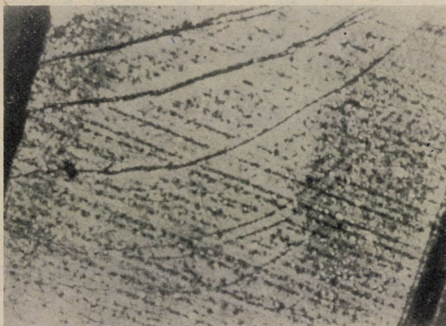
13. ábra. A 12. ábra kristályfelületét mutatja be két perces nedves levegőben való besugárzás után. Itt is jól látható, hogy a fotolitikus Zn elsősorban a rétegződési hibák mentén és a törési lépcsők mentén helyezkedik el. Különösen jelentős, hogy a kép alsó részén levő hibás rétegek mentén is megjelenik a Zn, amely rétegek optikai mikroszkóppal nem voltak kimutathatók (ld. a 12. ábrát). Ilyen módon ez a megfigyelés azt bizonyítja, hogy ZnS kristályok bizonyos rács rendezetlenségeit a fotolízis jelenségének segítségével láthatóvá lehet tenni
