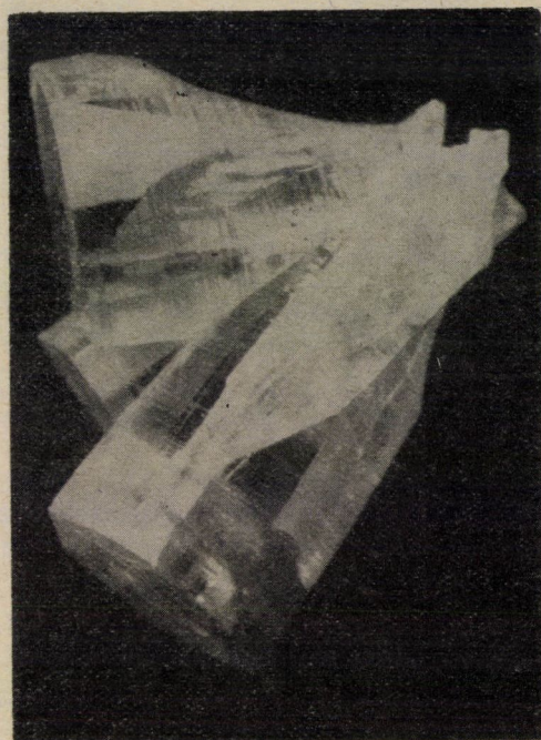
2. ábra. Prizma alakú ZnS egykristály. A kályha magas hőmérsékletű zónájában kb. 1300 C °-on keletkezett. Mérete 3 mm (hossz)
