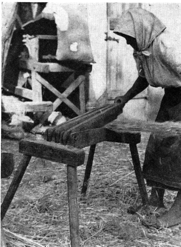
16. ábra. Deszkás szerkesztésű, hármás vágóélű tiló. Kocs, Komárom m.
