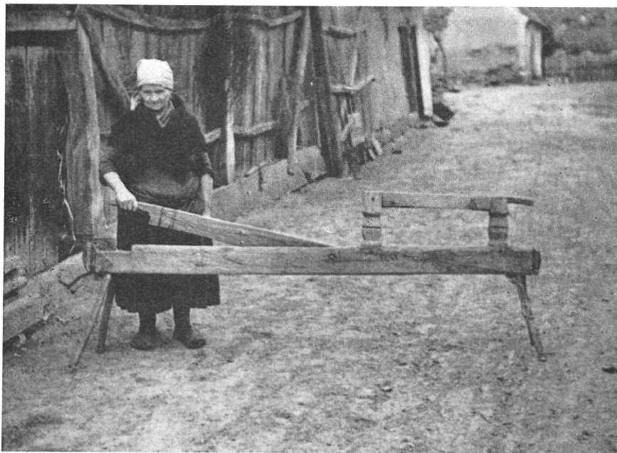
26. ábra. Kétvégű tiló: törésre és tisztításra. Babócsa, Somogy m.
