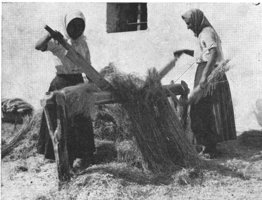
7. ábra. Ágafás lábmegoldás kétvégű tilónál. Bugac, Kecskemét.
